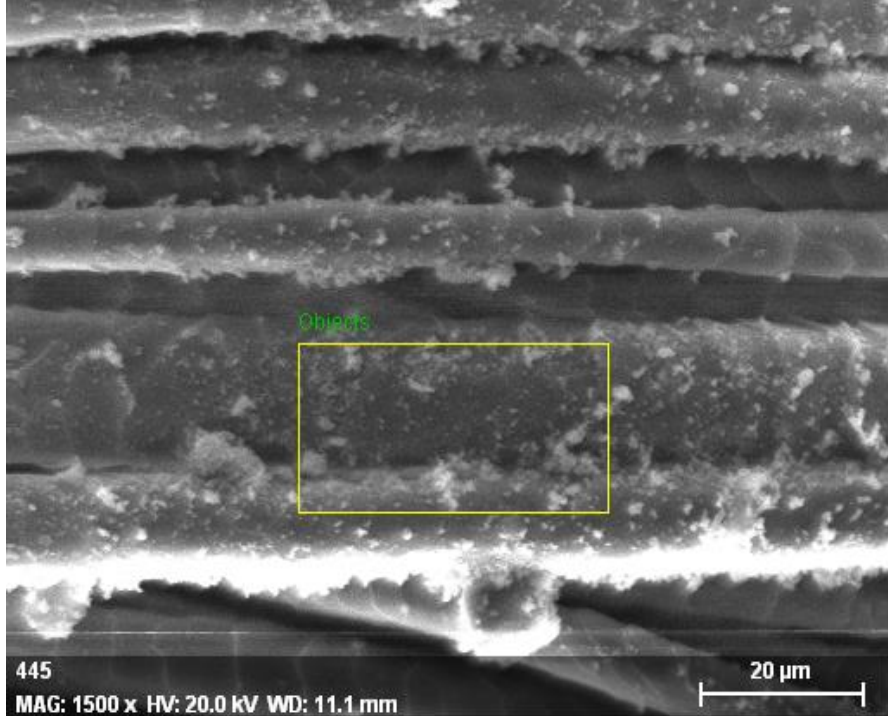
Şekil 4.20. Aynı gün ölçümü yapılmış 10 dakika plazma uygulaması görmüş normal şartlar altında muhafaza edilmiş yün kumaş
