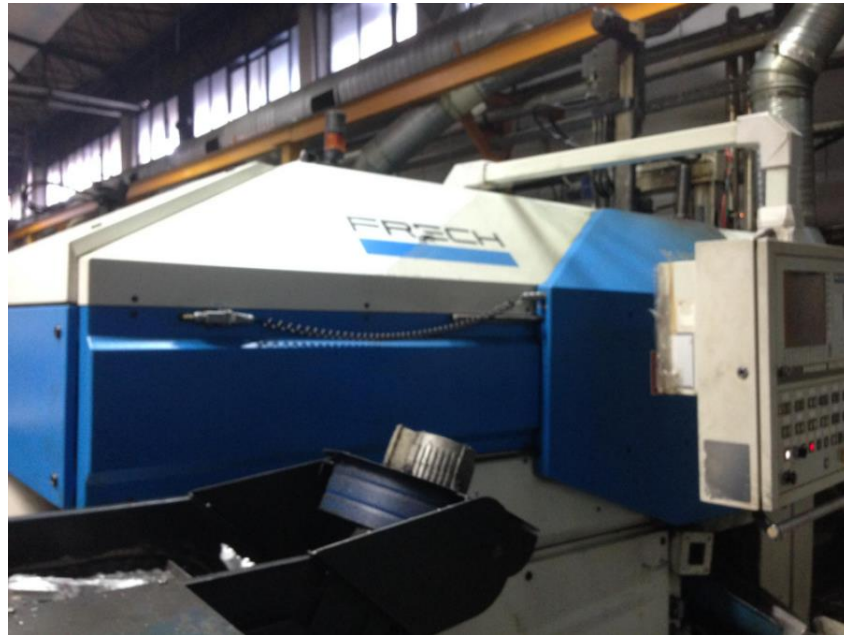
Şekil 3.4. Numune üretiminin gerçekleştirildiği basınçlı döküm makinesi
