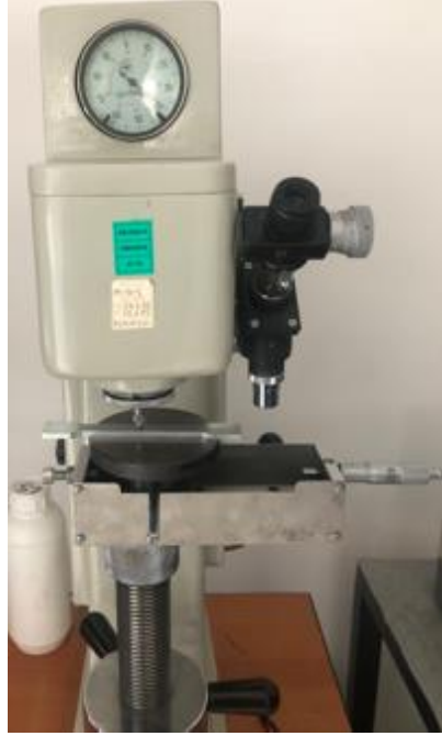
Şekil 3.8. Sertlik deneyinin gerçekleştirildiği sertlik ölçüm cihazı
