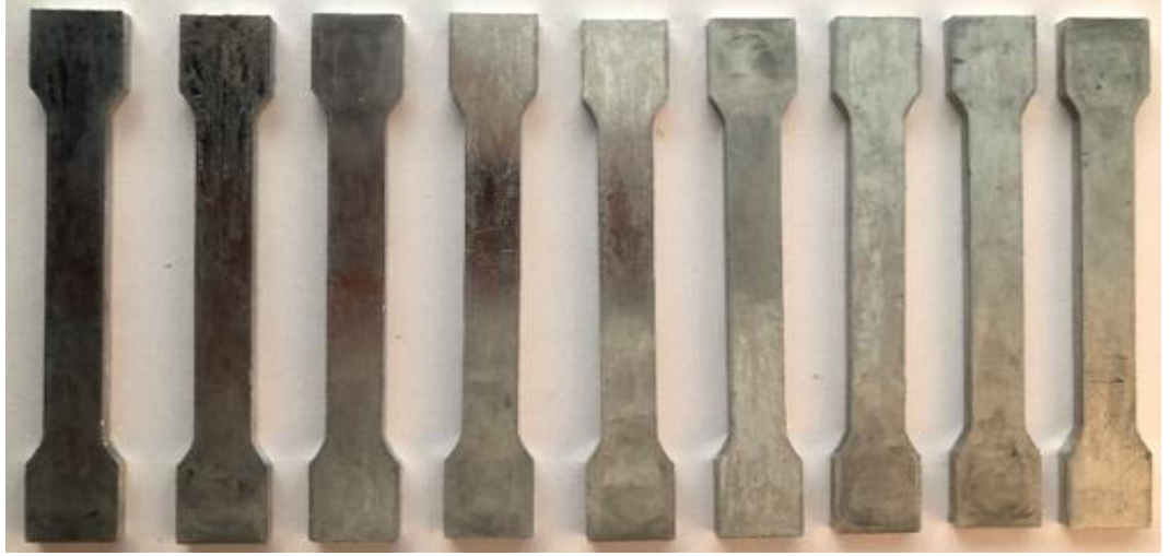
Şekil 3.7. Tez çalışmasında kullanılmak üzere Zamak 5 numuneler
