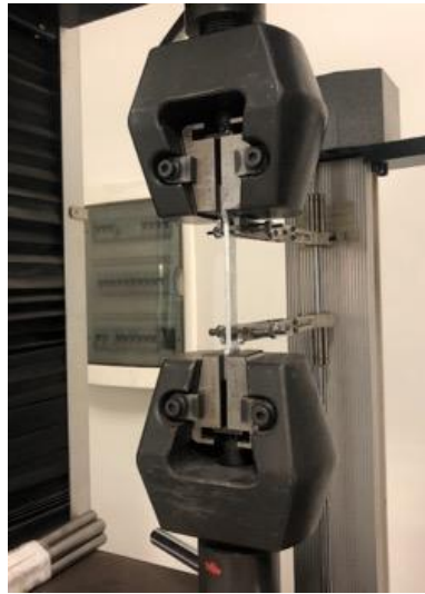
Şekil 3.6. Çekme deneyinin gerçekleştirildiği çekme deneyi cihazı
