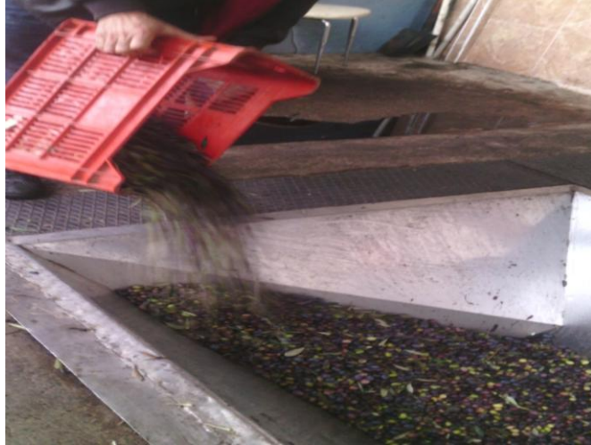
Şekil 3.2. Zeytinin temizleme ve aktarma işlemi
