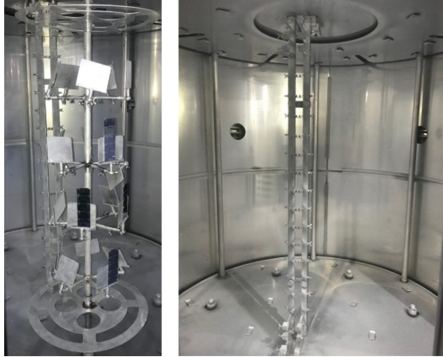
Şekil 4.17. Prototip kaplama planeti ve 20 filaman seri bağı evaporasyon kulesi
