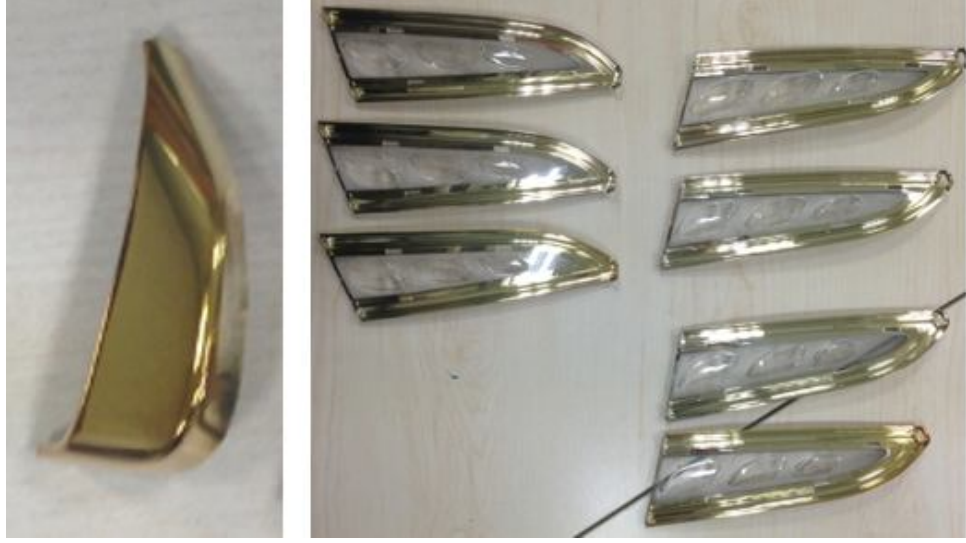
Şekil 3.9. Tamamı kaplanan kapatıcı panel ve kısmi kaplı optik çerçeveler
