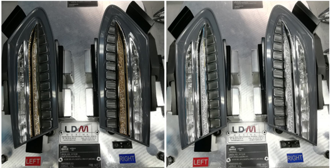
Şekil 4.52. Alüminyum ve Rose-Gold ürünlerin hat sonu makinasında pozisyonlanması
