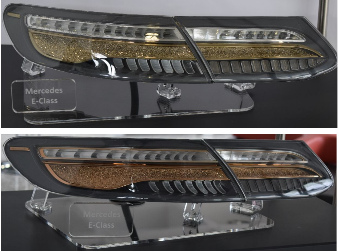
Őekil 5.4. Gold ve Rose-Gold renkli alt paralar ile retilen arka stop lambası (soęuk halde)
