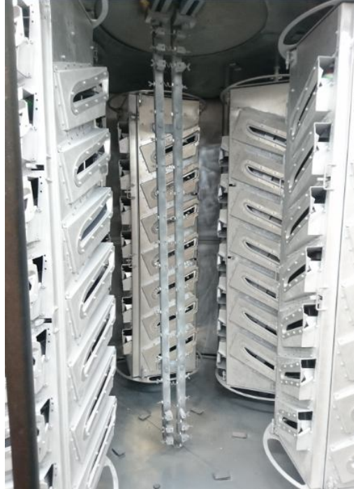
Şekil 3.4. Elektrot çubuğunun ve filamanların çan içerisindeki konumu
