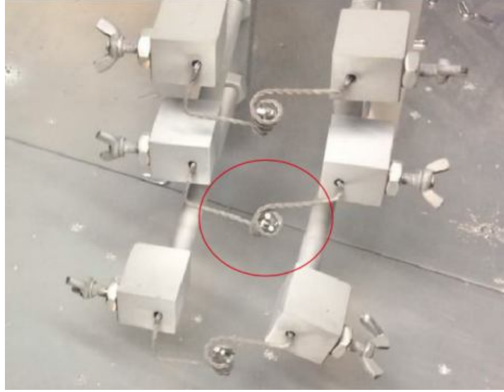
Őekil 4.9. Sepet tipi filamanın ısı etkisiyle çarpılması
