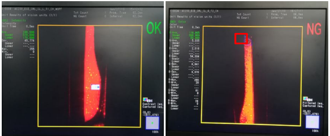
Şekil 4.45. Sırasıyla sol ve sağ EOL kontrolü
