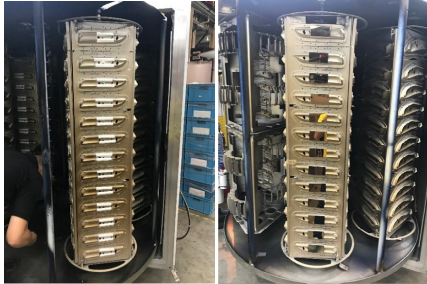
Şekil 4.30. Plakaların planet üzerine pozisyonlandırılmaları ve kaplanmış halleri
