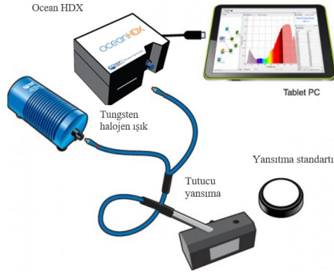
Şekil 4.29. Spektrometre ölçüm metodu
