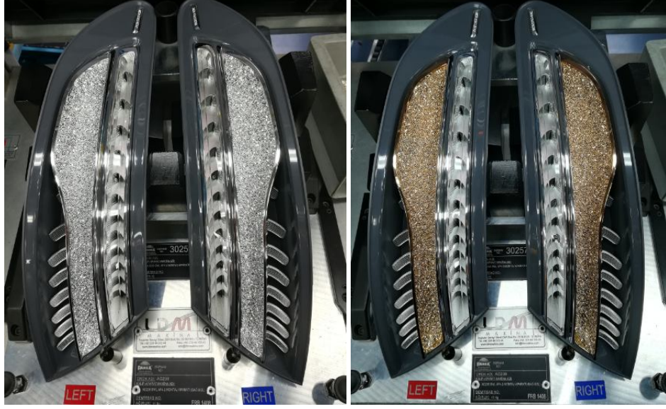
Şekil 4.44. Alüminyum ve Rose-Gold ürünlerin hat sonu makinasında pozisyonlanması
