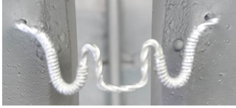
Şekil 3.14. Tungsten filamana sıvanmış ergimiş alüminyum
