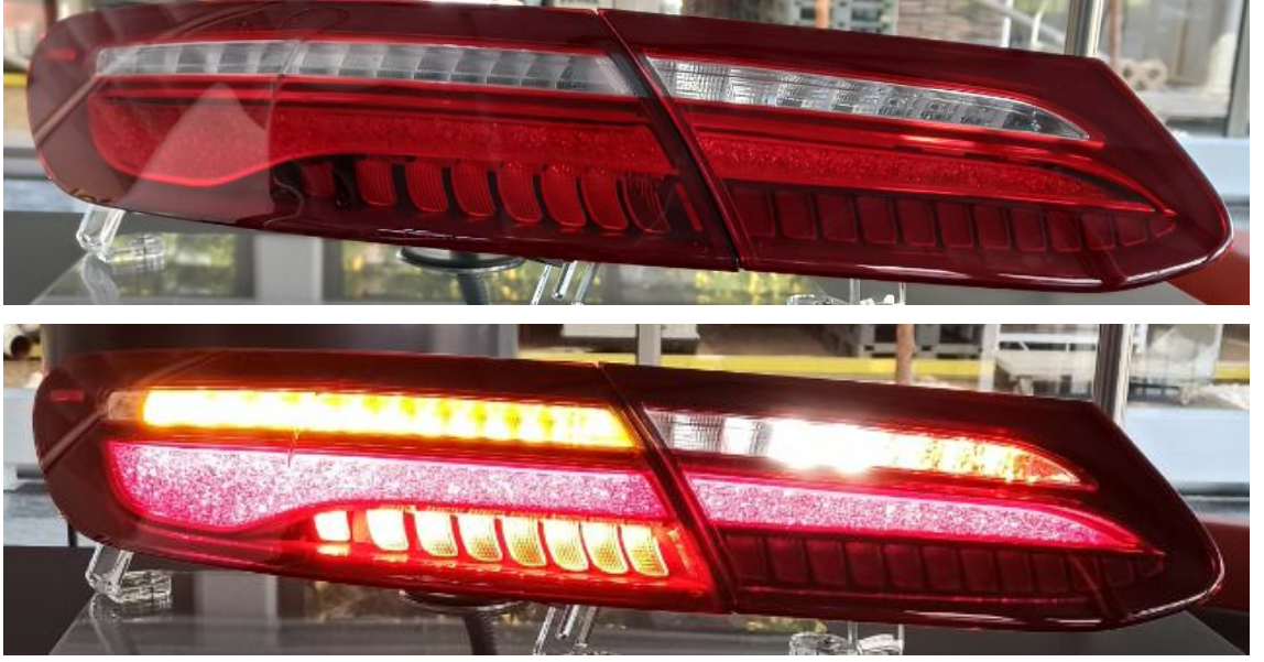
Şekil 5.2. Orijinal alt parçaları ile üretilen arka stop lambası (sırasıyla soğuk ve sıcak halde)
