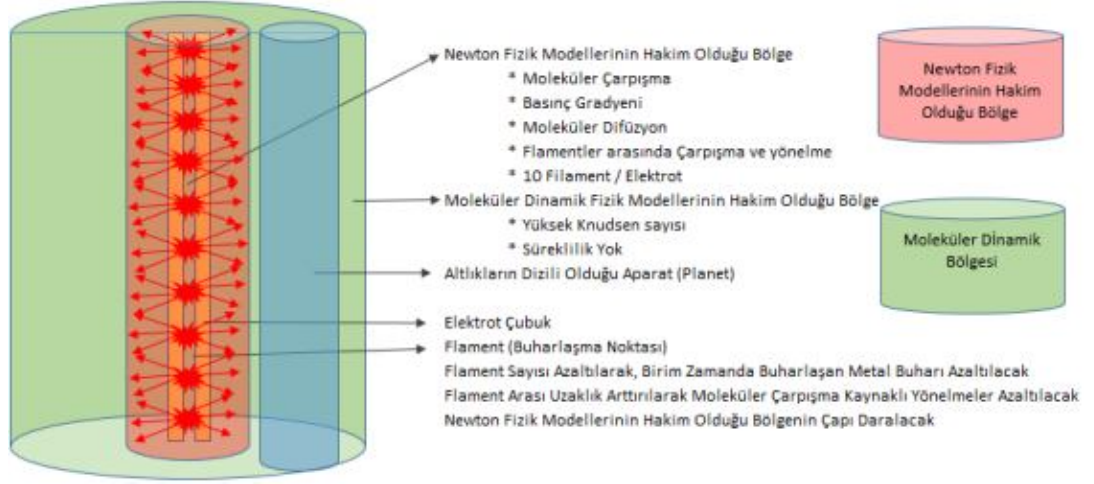
Şekil 4.14. İyileştirilmiş durum basınç gradyanları olan bölgenin sınırlarının daraltılması
