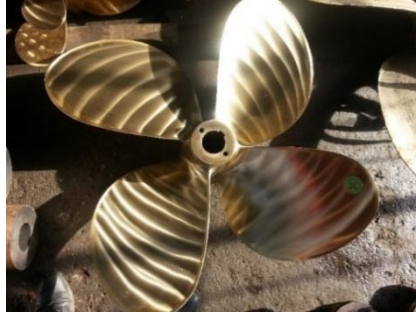
Şekil 3.6. CuAl8 alaşımından üretilmiş gemi pervanesi
