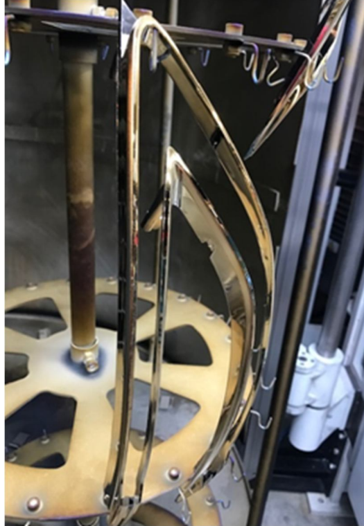
Şekil 4.23. Filaman sayısı belirlenmiş dikine homojenite sağlanmış parçalar
