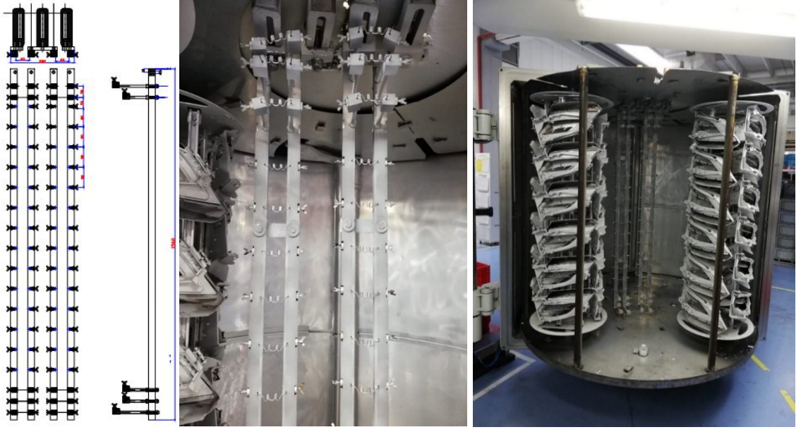
Şekil 4.1. Çift evaporasyon kulesi çizimi ve çan içerisinde görünümü
