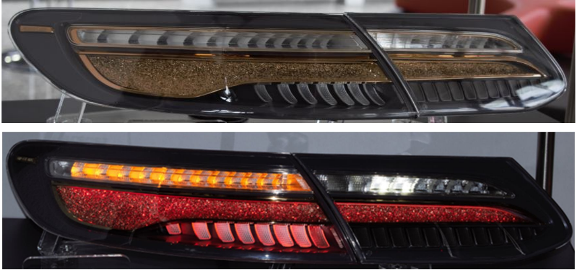
Şekil 5.3. Rose-Gold renkli alt parçalar ile üretilen arka stop lambası (sırasıyla soğuk ve sıcak halde)
