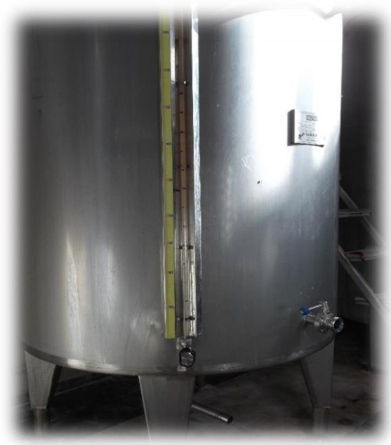
Şekil 2.10. Durultma ve asitlik giderme tankı
