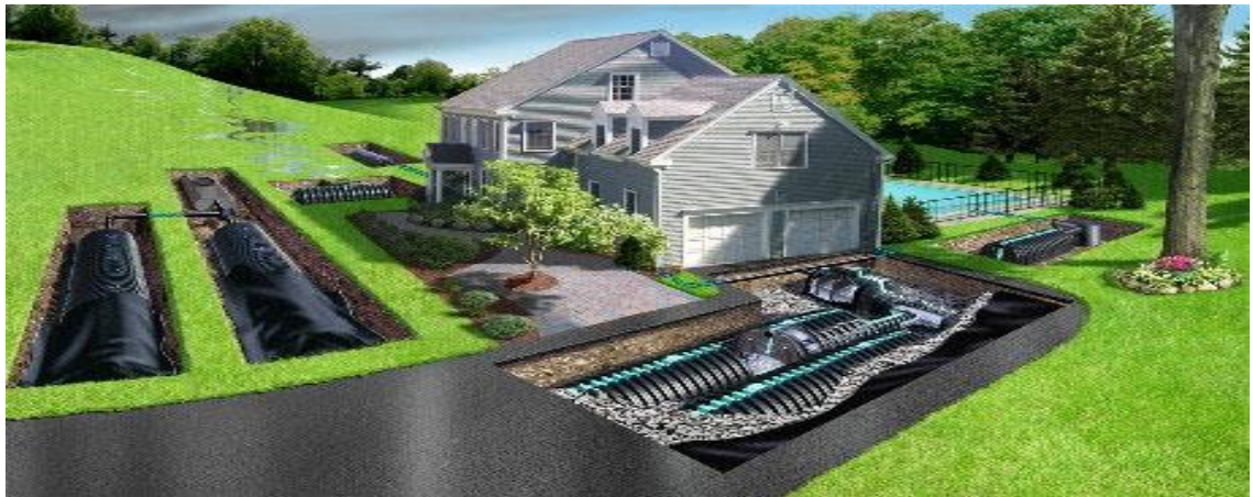
Şekil 2.4. Yeraltına sızdırma sistemleri
