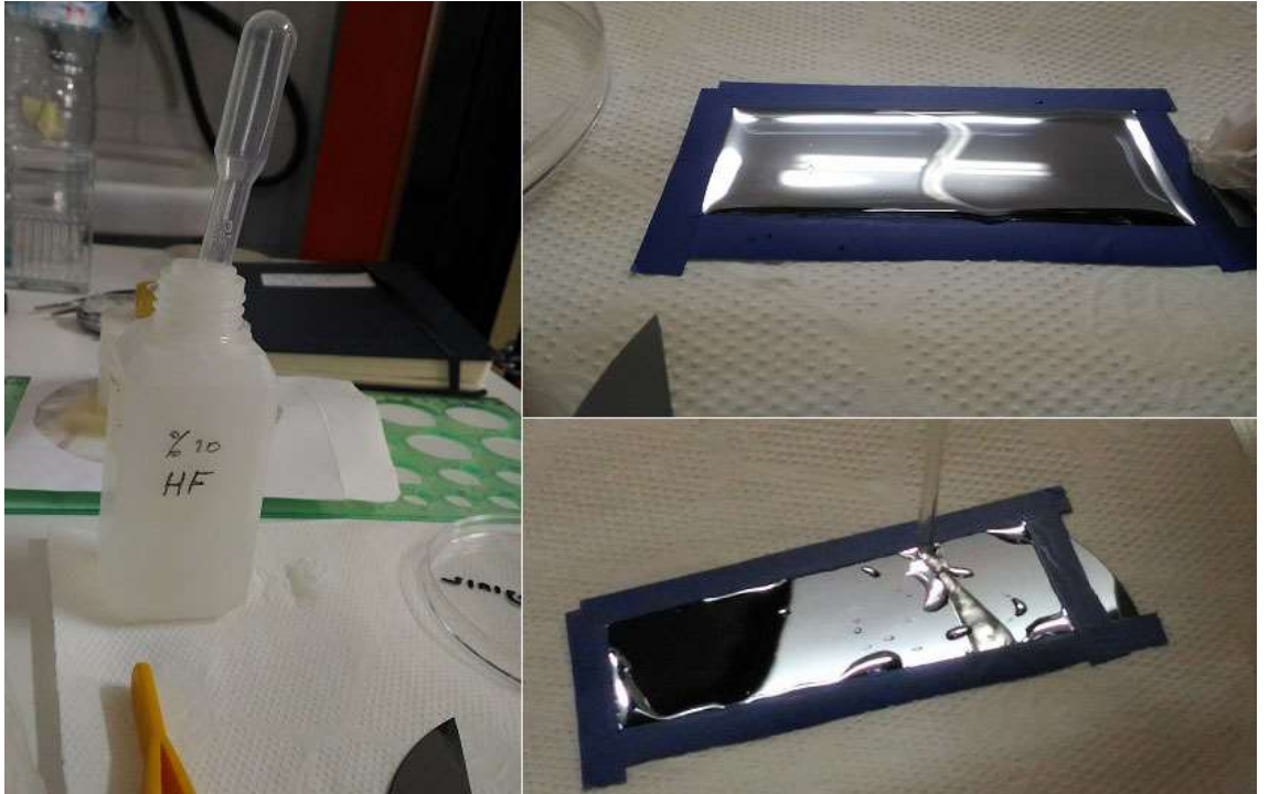
Şekil 3.4. Maskelendirme ve HF asit çözeltisi ile aşındırma işlemi.
