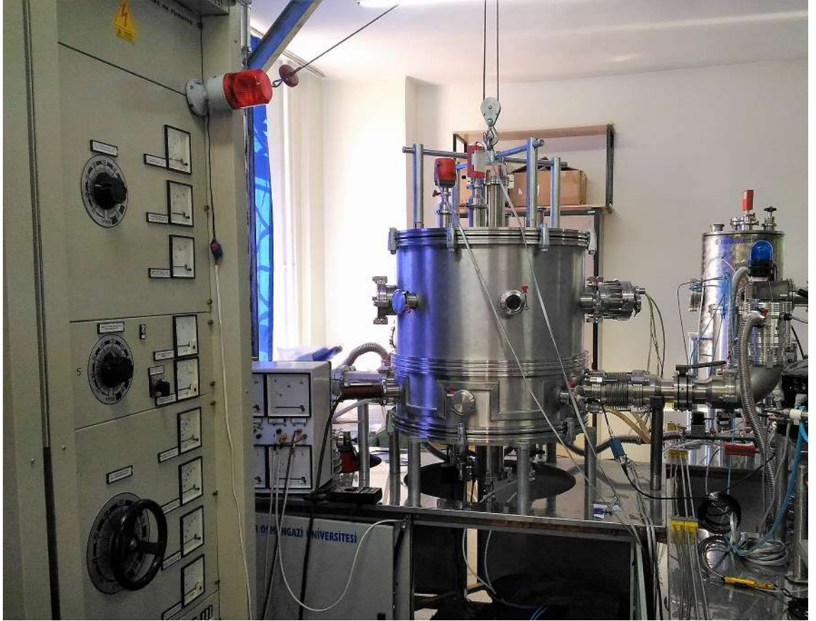
Şekil 3.2. ZnS ince filmin üretildiği TVA sisteminin bir görüntüsü.
