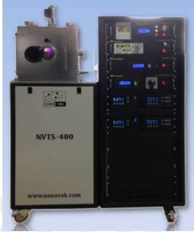
Şekil 3.3. Ohmik kontaktların kaplandığı “Nanovak NVTS-400” termal buharlaştırma sistemi.
