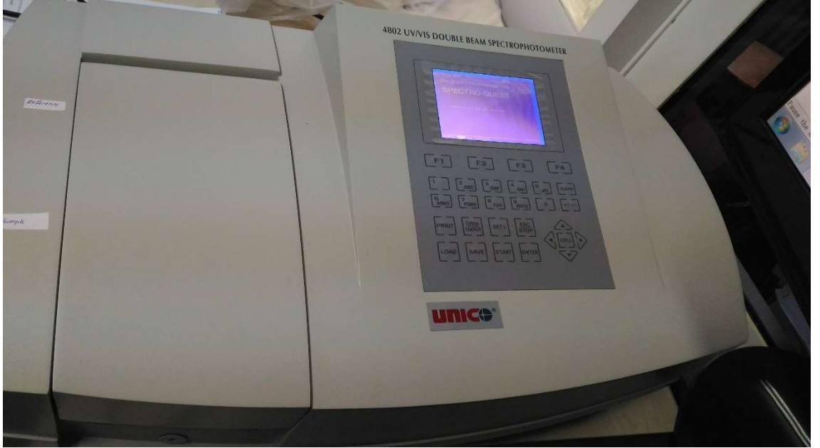
Şekil 3.8. UNICO SQ4802 UV/VIS Spektrofotometre sistemi görüntüsü.
