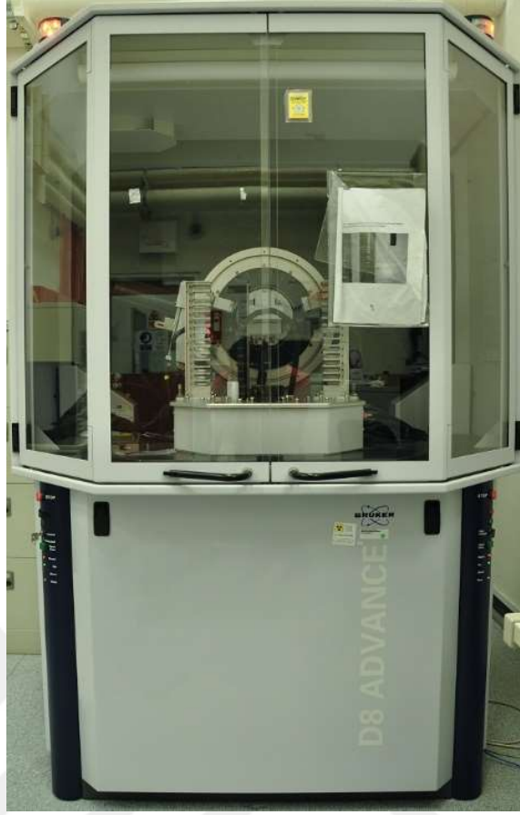
Şekil 3.9. Bruker D8 Advence X-Işınları kırınımı cihazı.
