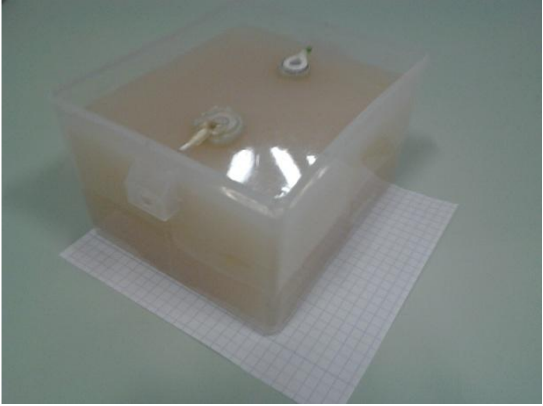
Şekil 3.6 Hazırlanmış jel fantomun MRI taramasından önce çekilmiş fotoğrafı
