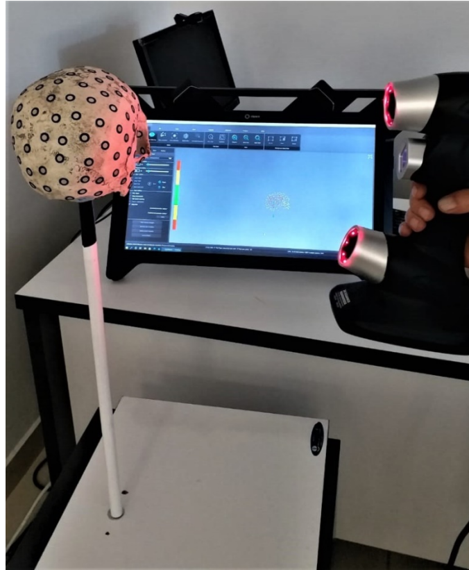
Şekil 34. HScan Prince ile tarama yapılması
