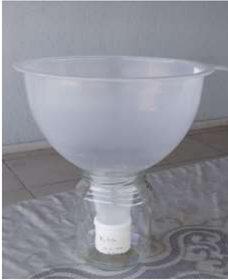
Şekil 3.4. Bitki ekstraksiyonları için kullanılan el yapımı Berlese hunisi'nden bir görüntü
