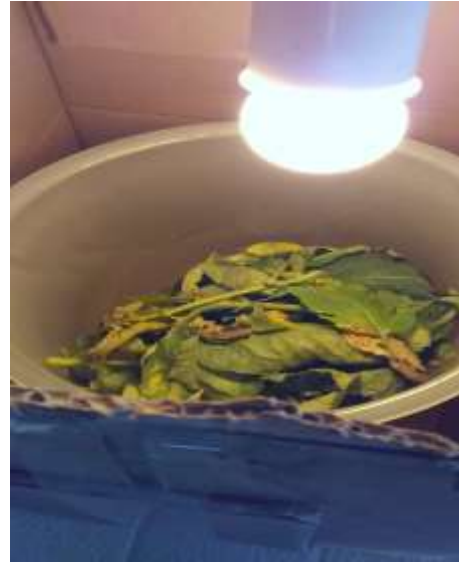
Şekil 3.4. Bitki ekstraksiyonları için kullanılan el yapımı Berlese hunisi'nden bir görüntü
