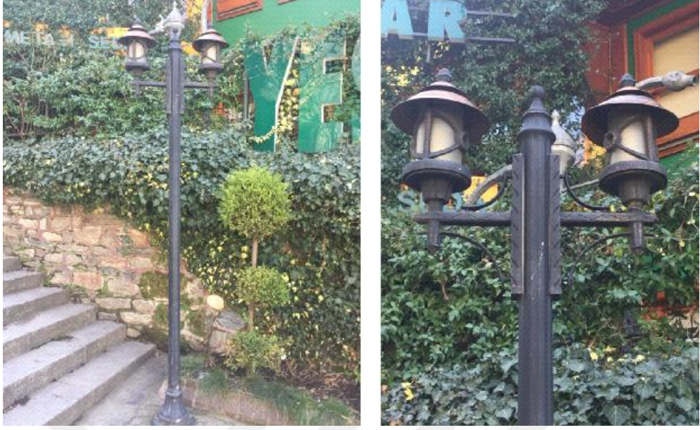
Şekil 4.254. Çift armatürlü ferforje detaylı yaya yolu aydınlatması ve armatür detayı (Fotoğraf: Gülşah MERCAN 2017)
