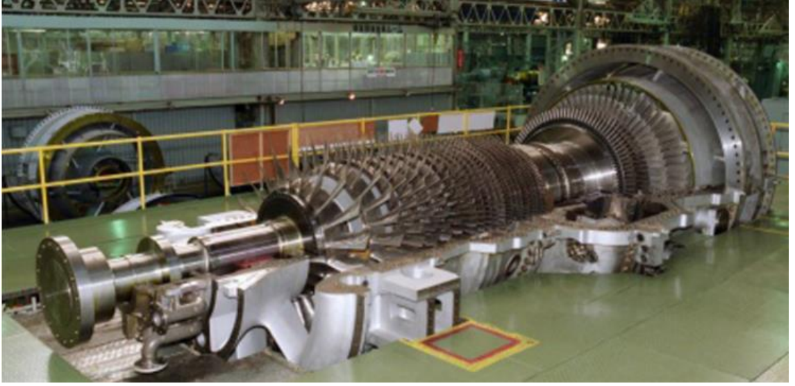
Şekil 1.5. Trijenerasyon sisteminde kullanılan gaz türbini örneği
