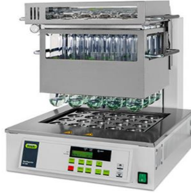
Şekil 3.9. Blok yakma sistemi
