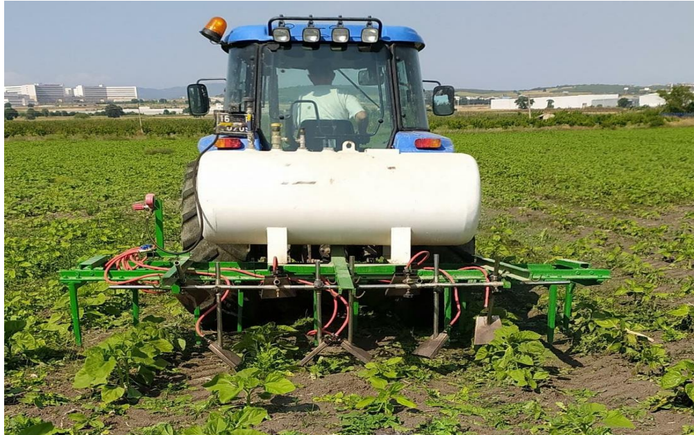
Şekil 3.3. İki metre iş genişliğine sahip sıra üzeri alevleme makinesi
