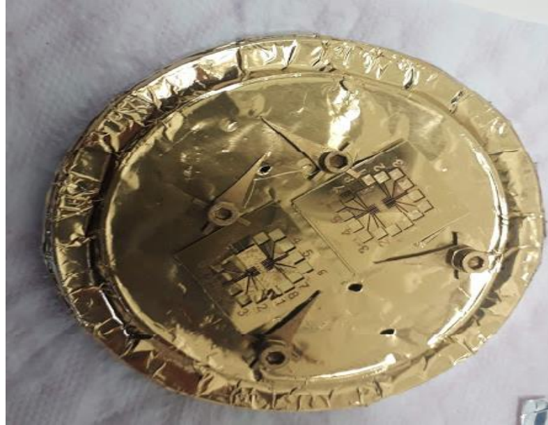
Şekil 3.4. Maske yardımıyla altın Schottky ve transistör kontaklarının alınması
