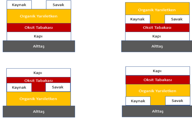
Şekil 2.10. OFET 'lerde kontakların konumuna göre aygıt üretim yapıları
