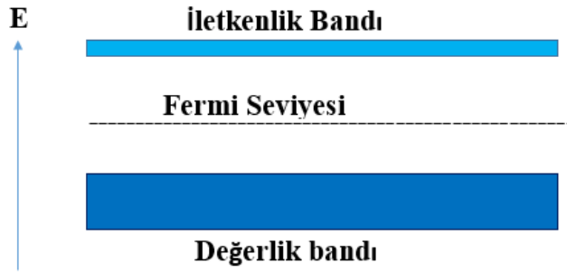
Şekil 2.2. Saf yarı iletkenlerde fermi seviyesi
