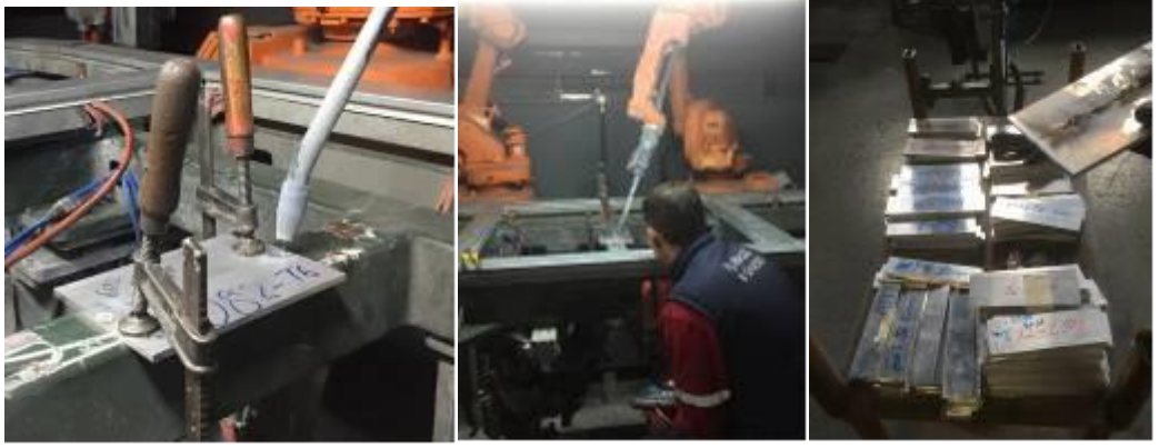
Şekil 3.7. Kupon bazlı kaynak denemelerinin yapıldığı üretim hattı görseli
