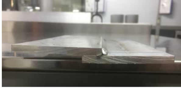
Şekil 3.8. Kupon bazlı kaynak çalışmalarının sonrasında bindirme kaynağı yapılmış örnek numunenin görseli
