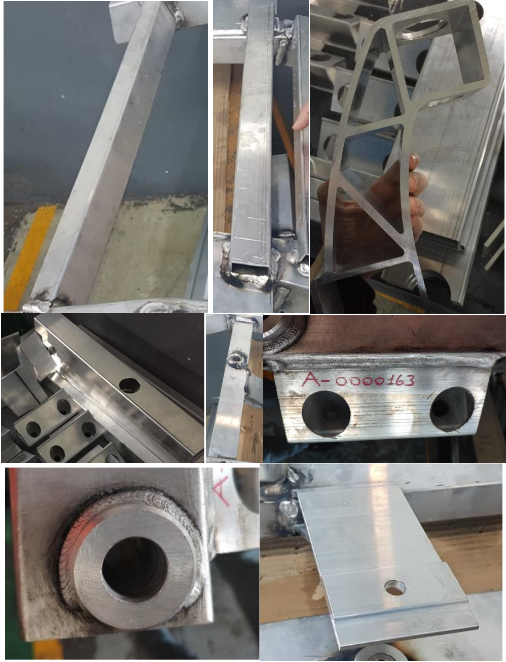
Şekil 4.63. Alüminyum ekstrüzyondan geliştirilmiş motor beşiğinin alt parçaları görseli
