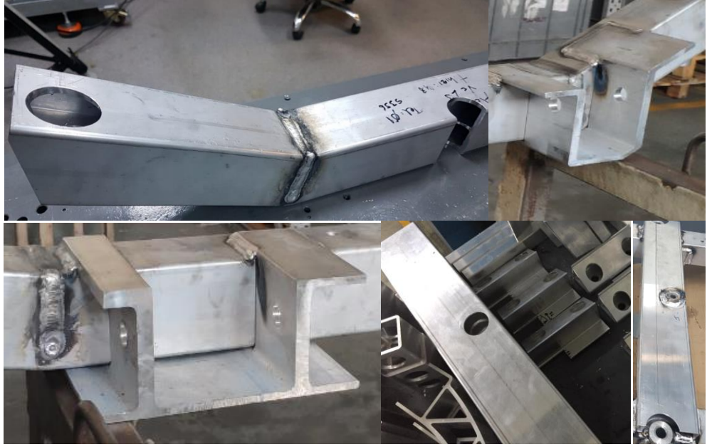
Şekil 4.62. Alüminyum ekstrüzyondan geliştirilmiş motor beşiğinin alt parçaları görseli
