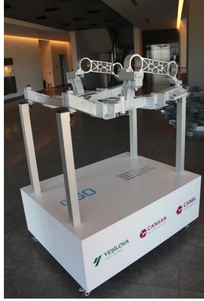
Şekil 4.65. Yeşilova Holding Ar-Ge Merkezi'nde stantta potansiyel müşterilere tanıtılan alüminyum motor beşiği görseli
