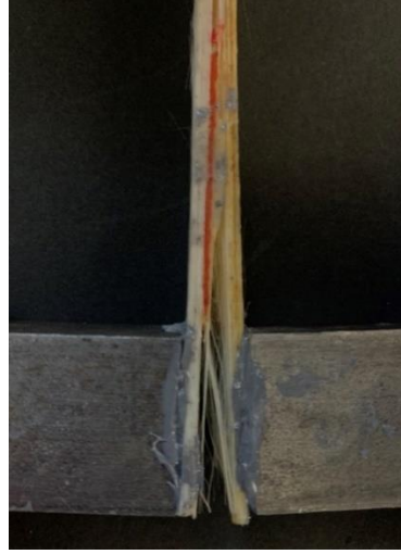
Şekil 4. 3. DCB testi sonrası numunede oluşan hasar
