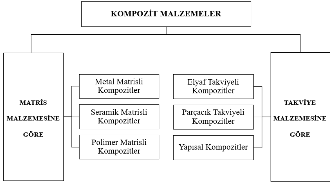
Şekil 2. 18. Kompozit malzemelerin sınıflandırılması
