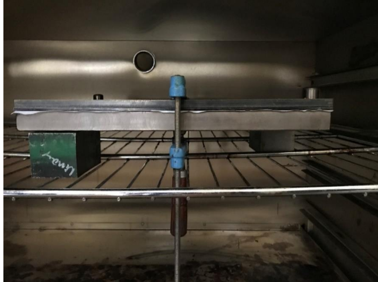
Şekil 3. 5. Fırın içerisine yerleştirilmiş kalıp
