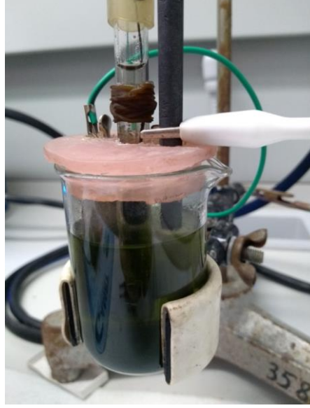
Şekil 4.5. PPy/rGO kompozit filminin elektrodepozisyonu
