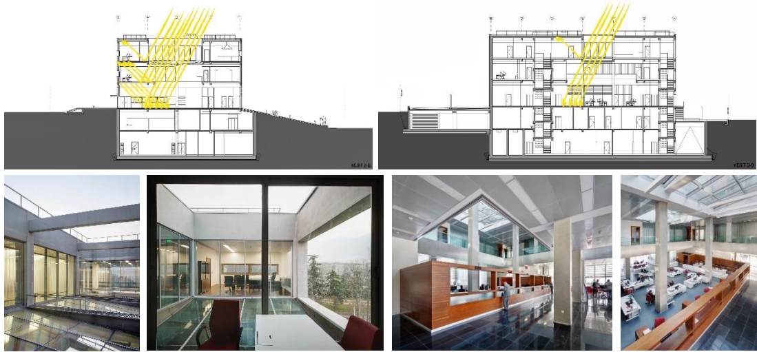
Şekil 4.12. Bursa Merkez Binası çatı ışıklığı (Anonim 2012)
