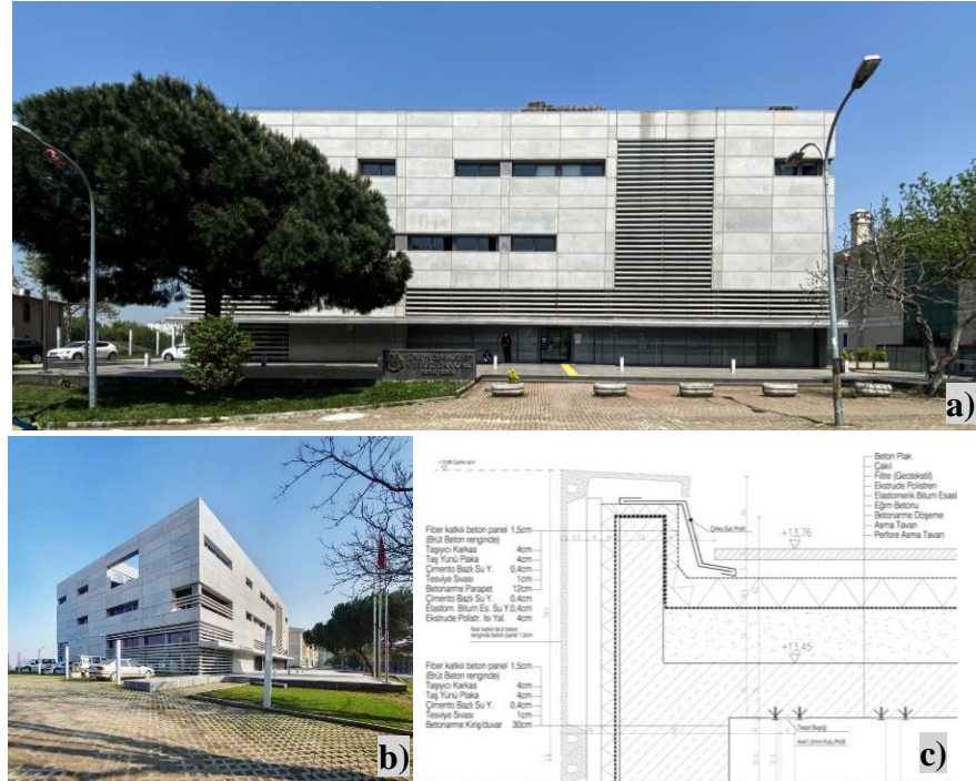
Şekil 3.171. Bursa Merkez Bankası ve detay kesit (a: Fotoğraf: Büşra Canbakış, b, c: Anonim 2012)
