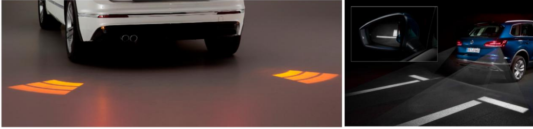
Şekil 2.14. Geri vitese geçildiğinde sürüş güvenliğini arttırmak için tasarlanmış PLL örnekleri (Studeney, 2019)
