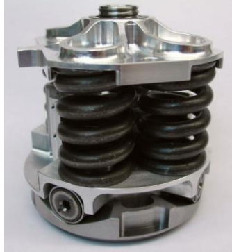
Şekil 2.13. VS-Joint mekanizması gösterimi (Wolf, 2008)
