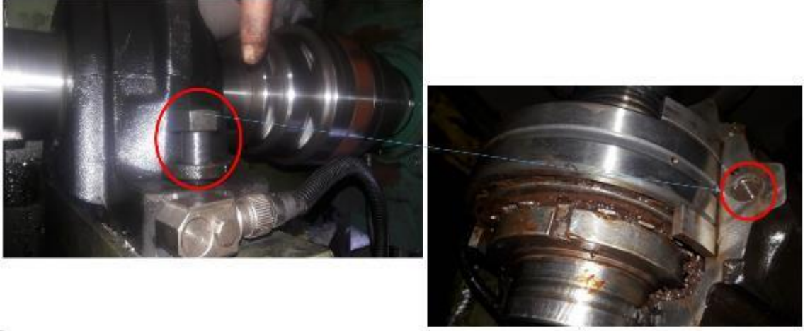
Şekil 4.6 Ana motor 3 numaralı yatak cıvata problemi
