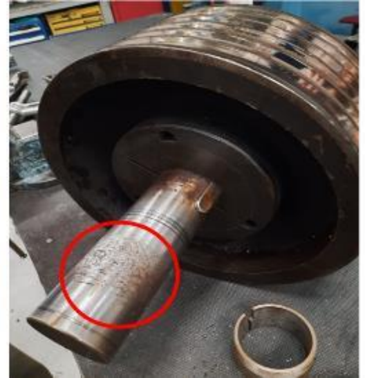
Şekil 4.3 Bakım yapılan 4 numaralı yatak rulmanı ve kasnak grubu
