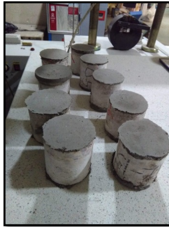
Şekil 3.2. Silindirik karot numuneleri ve basınç dayanımının belirlenmesi (PROTEST Yapı Araştırma ve Test Merkezi, 2019)
