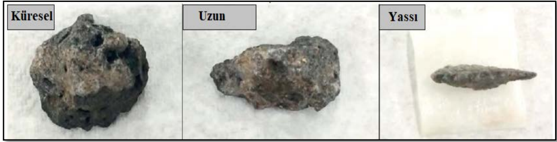
Şekil 4.5. Geri dönüştürülmüş beton agregası tane şekilleri
