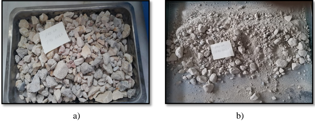
Şekil 3.12. 50GDBA karışımının a) LA aşınma deneyi öncesi, b) LA aşınma deneyi sonrası görünümü
