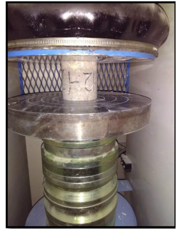
Şekil 3.2. Silindirik karot numuneleri ve basınç dayanımının belirlenmesi (PROTEST Yapı Araştırma ve Test Merkezi, 2019)
