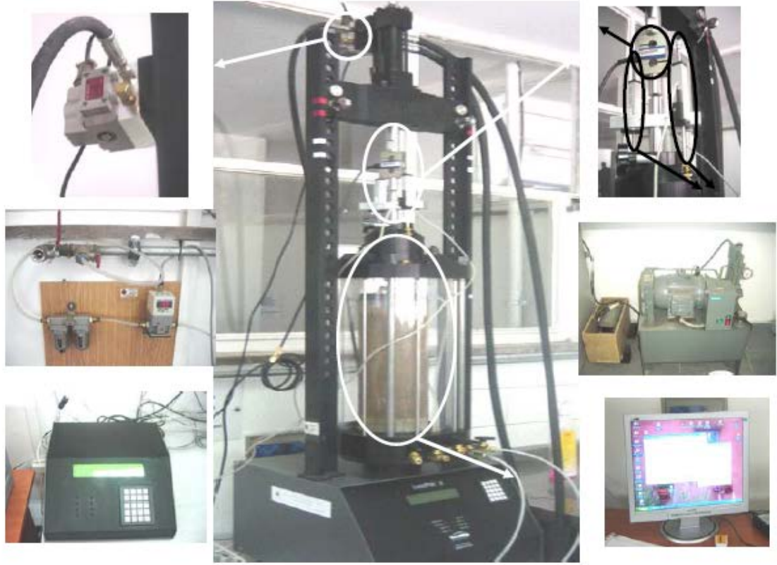
Şekil 3.23. Esneklik modülü deneyi cihaz sistemi
