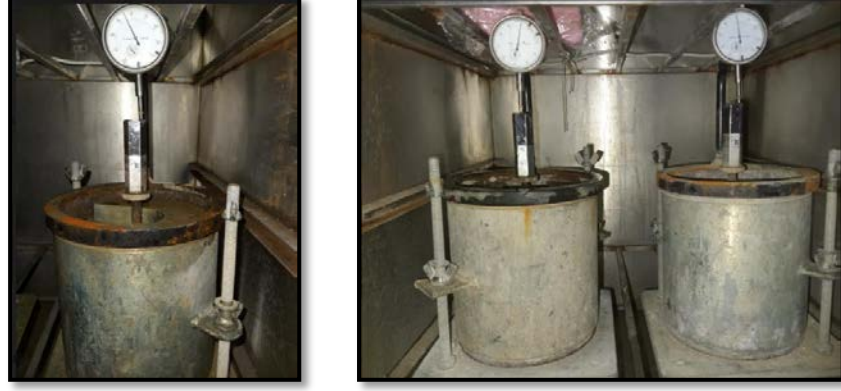
Şekil 3.19. Donma-Çözülme kabineine yerleştirilen 100GDBA karışımları
