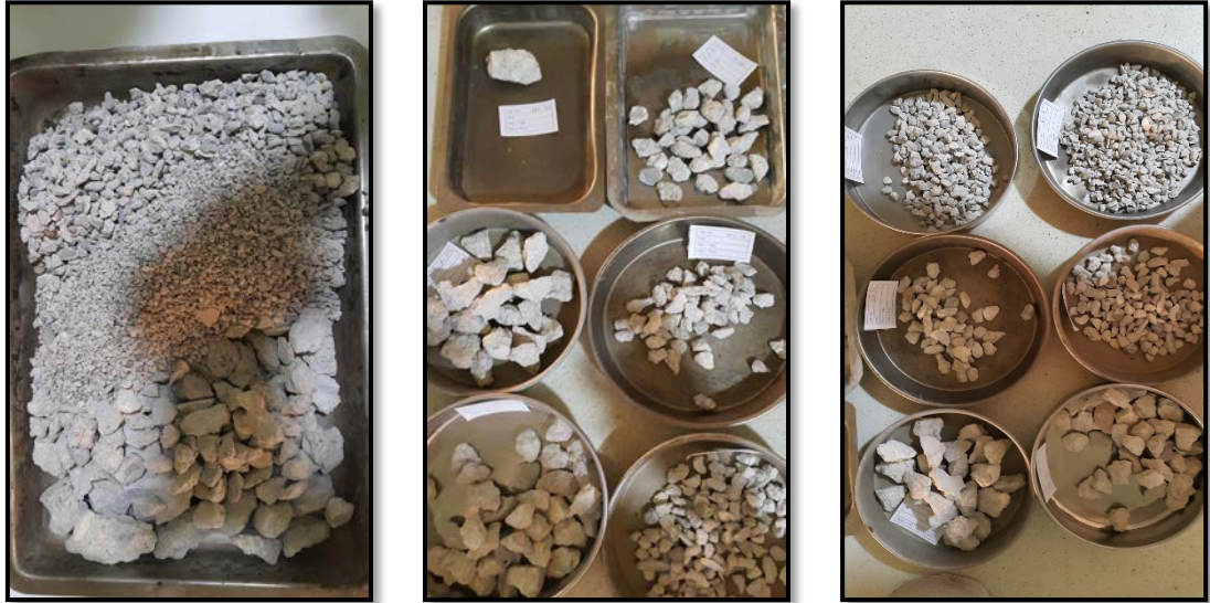
Şekil 3.14. Yassılık endeksi belirlenmek için hazırlanan 100GDBA karışımı ve kare gözlü elek üzerinde kalan numuneler
