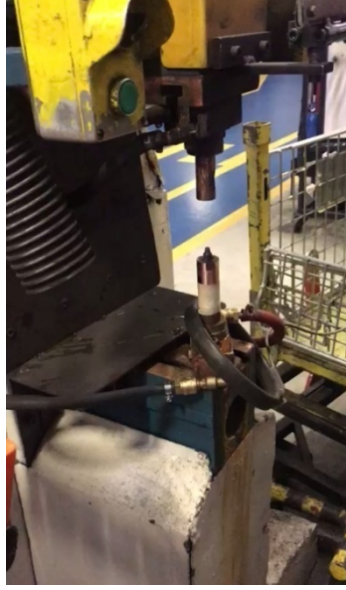
Şekil 3.16. Projeksiyon kaynağının uygulandığı kaynak makinesi
