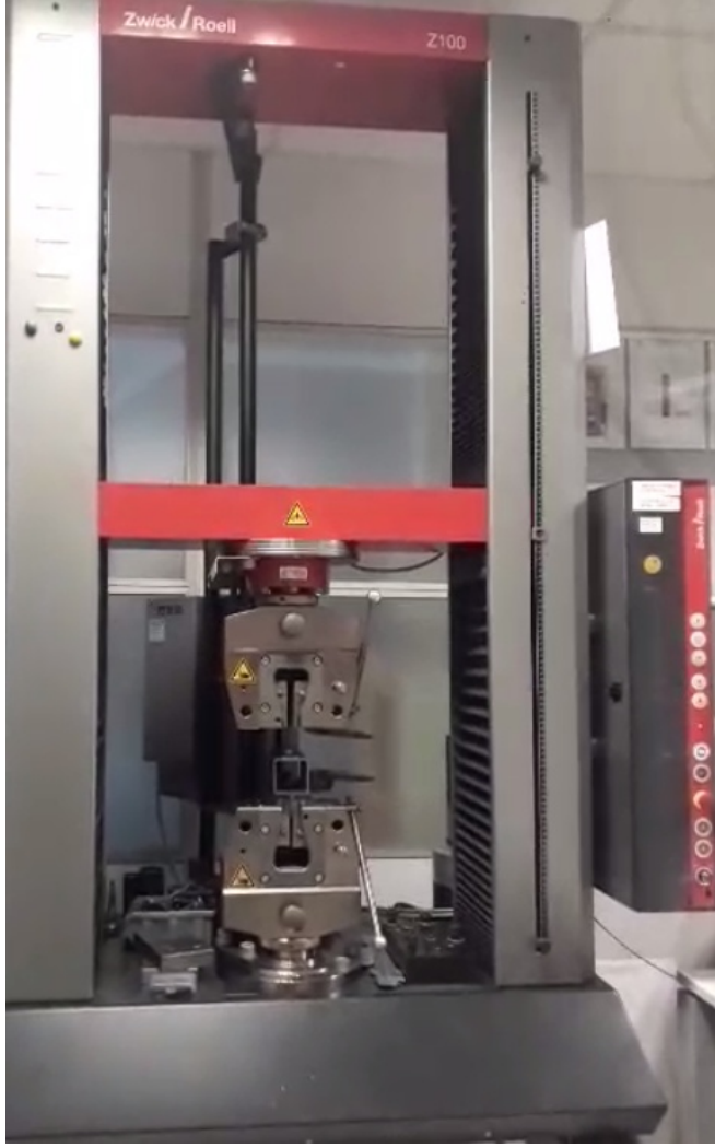
Şekil 3.20. Çekme testlerinin uygulandığı test cihazı
