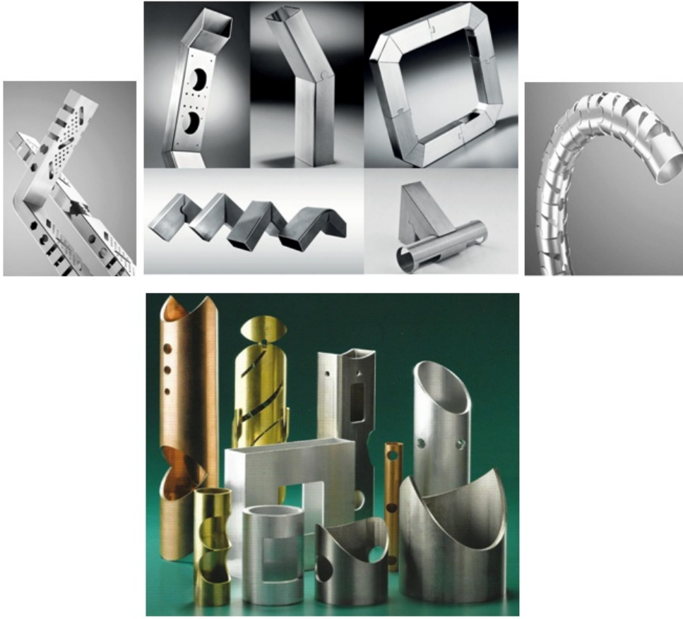
Şekil 3.7. Lazer profil kesim makinesi kesilen parça örnekleri (Anonim 2014)
