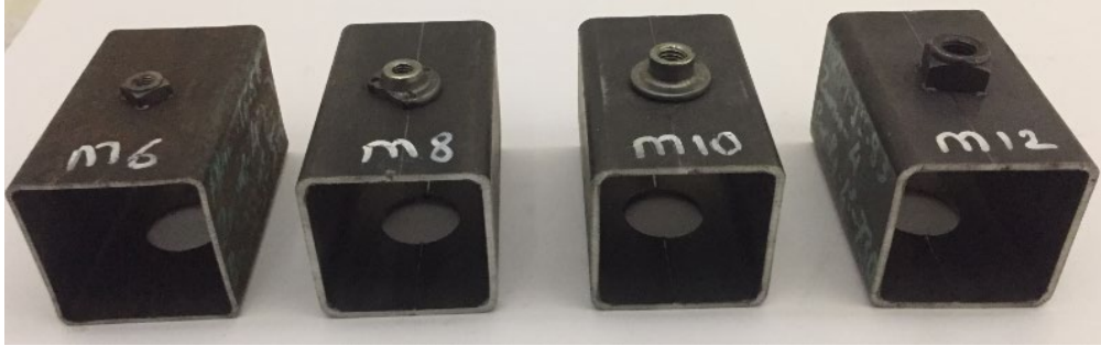
Şekil 3.18. Projeksiyon kaynağı ile hazırlanan kaynak somunlu numuneler
