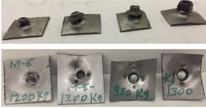
Şekil 3.15. Kaynatma parametrelerinin belirlenmesi için yapılan ön çalışma
