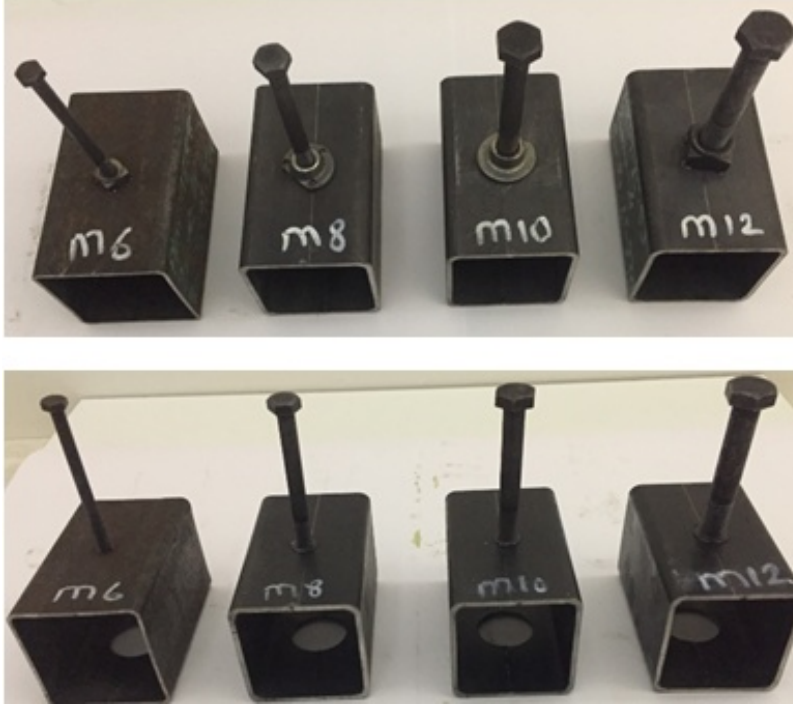
Şekil 3.19. Çekme testine hazırlanmış numuneler
