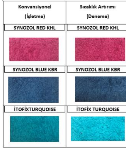
Şekil 4.43. Boyalı kumaşların konvansiyonel ve sıcaklık artışı ile yapılan yıkama sonrası D65 ışığı altındaki görselleri
