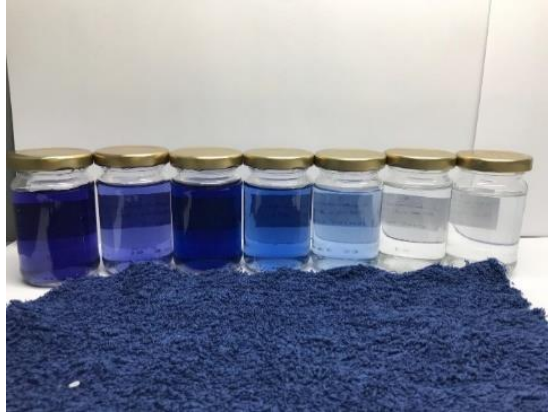
Şekil 4.19. Atıksularının tekrar kullanımı denenen “160165 navy” adlı karışım boyamasına ait, yıkama atıksuları görseli
