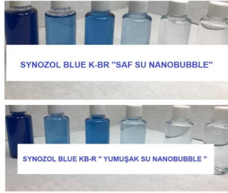
Şekil 4.49. Nanobubble jeneratöründen geçirilmiş saf ve yumuşak suların, reaktif yıkama prosesinde kullanımına ait atıksu görselleri
