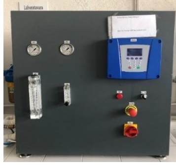
Şekil 3.5. Hava ve oksijen süspansiyonlu nanobubble jeneratörü
