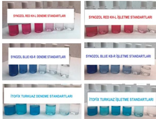
Şekil 4.30. Konvansiyonel (işletme standartları) ve aynı prosesin difüzyon fazında 95°C’ de yıkama yapılarak elde edilen çözeltileri
