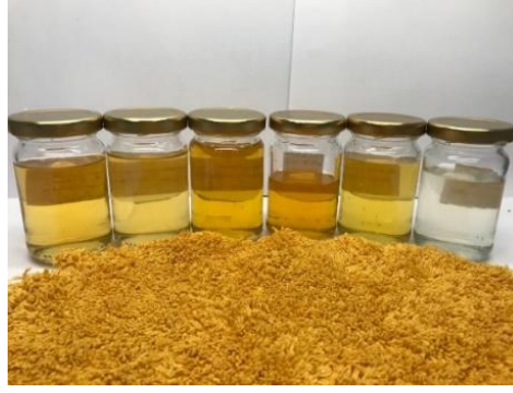
Şekil 4.15. Atıksularının tekrar kullanımı denenen “120303 yellow” adlı karışım boyamasına ait, yıkama atıksuları görseli
