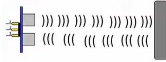
Şekil 3. 10. Ultrasonik mesafe sensörü çalışma prensibi
