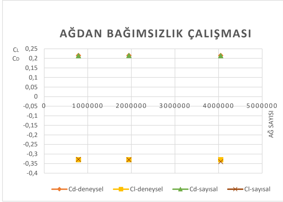
Şekil 3.28. Ağdan bağımsızlık çalışmaları sonucunda SST-k-w Türbülans modeli için deneysel ve analiz sonuçlarında aerodinamik özelliklerin kıyaslanması.
