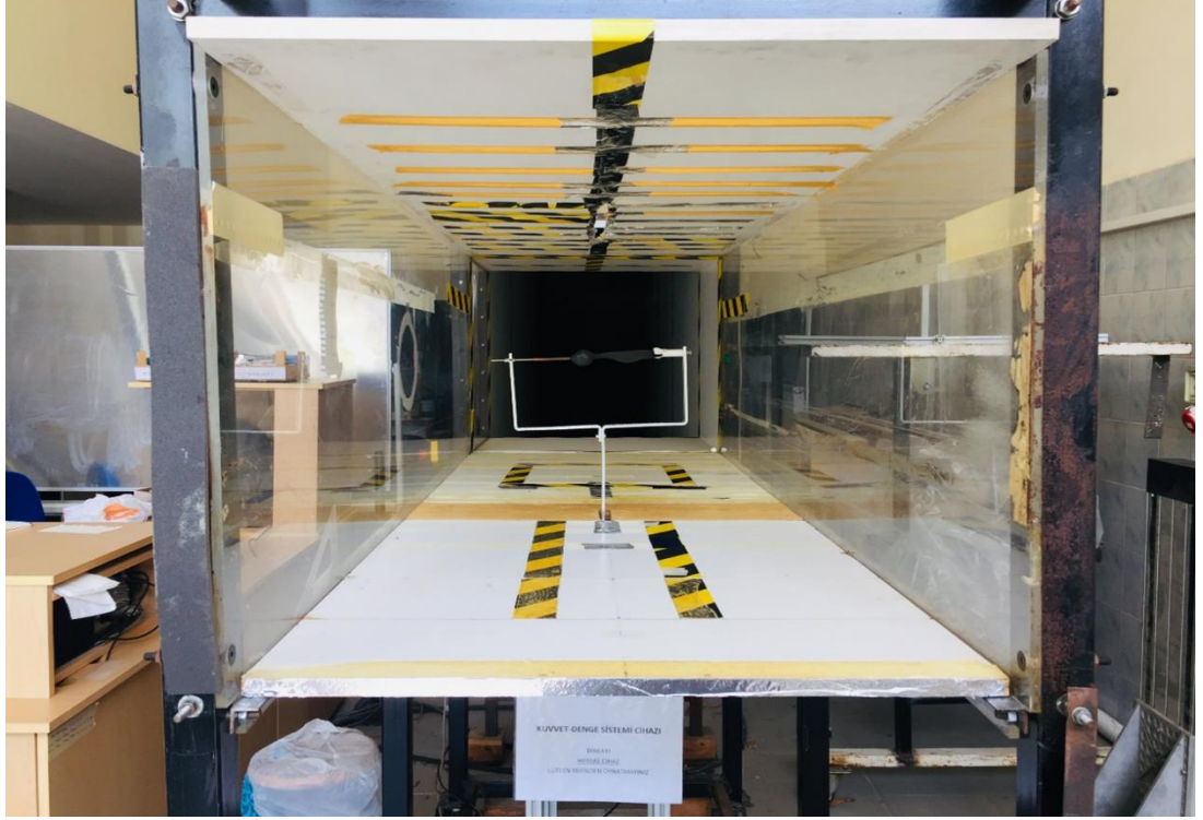
Şekil 3.19. Rüzgar Tüneli içerisine akçaagaç kanat modelinin ve aerodinamik kuvvet ölçüm cihazının yerleşimi
