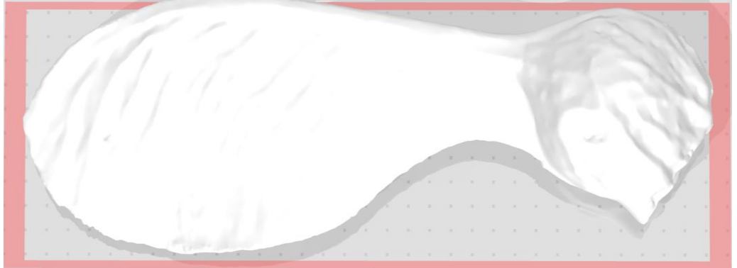
Şekil 3.11. Seçilen optimum tasarımdaki akçaağaç tohumunun 3D yazıcı da üretilmeden önceki 3D yazıcı programında birebir ölçeklendirilmiş resmi 1 numaralı akçaağaç tohumu (orjinal boyut )
