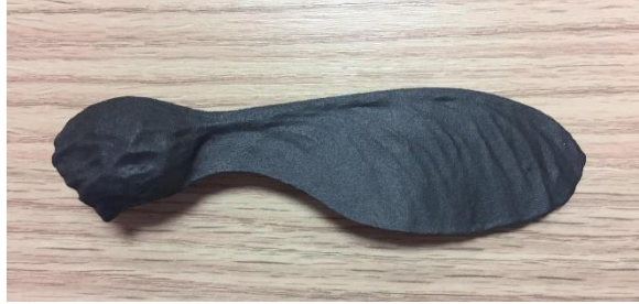
Şekil 3.16. 160 mm akçaağaç tohumu (samara) deneysel ve nümerik analizi için üretilmiş prototip kanat.
