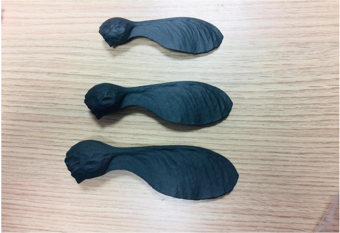
Şekil 3.15. 1 numaralı akçaağaç tohumunun 3 boyutlu optik tarayıcı sonrası görüntüleri
