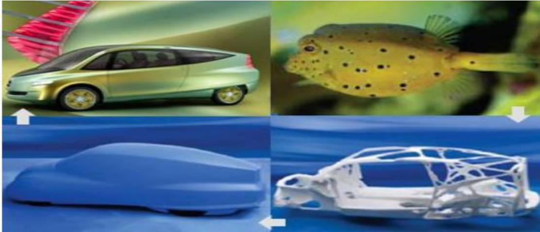
Şekil 1.2. Kutu balığından otomobil iskelet yapısı aerodinamik testler için çamur model Daimler Chrysler Prototip Biyonik Araç ( http://knowgeee.blogspot.com/2016/07/ )
