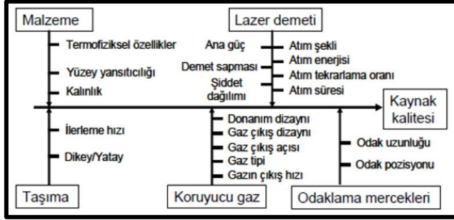
Şekil 3.4. Lazer kaynak kalitesini etkileyen parametreler (Aydın ve Karaağaç, 2010)
