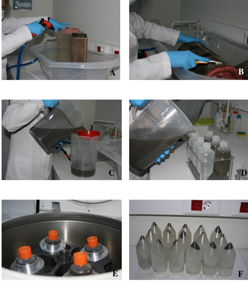
Şekil 3.8. Filtrelerin yıkanması ve santrifüjlenmesi A) Filtrelerin küvet içerisinde hortumla yıkanması B) Yıkanan filtrelerinin steril dış fırçası yardımı ile fırçalanması C) Yıkama suyundaki yabancı maddelerin giderilmesi için elenmesi D) Sıvının 250 ml konik dipli falkon tüplere aktarılması E) Tüplerin santrifüje yerleştirilmesi F) Santrifüj sonrası tüplerin ters çevrilmesi
