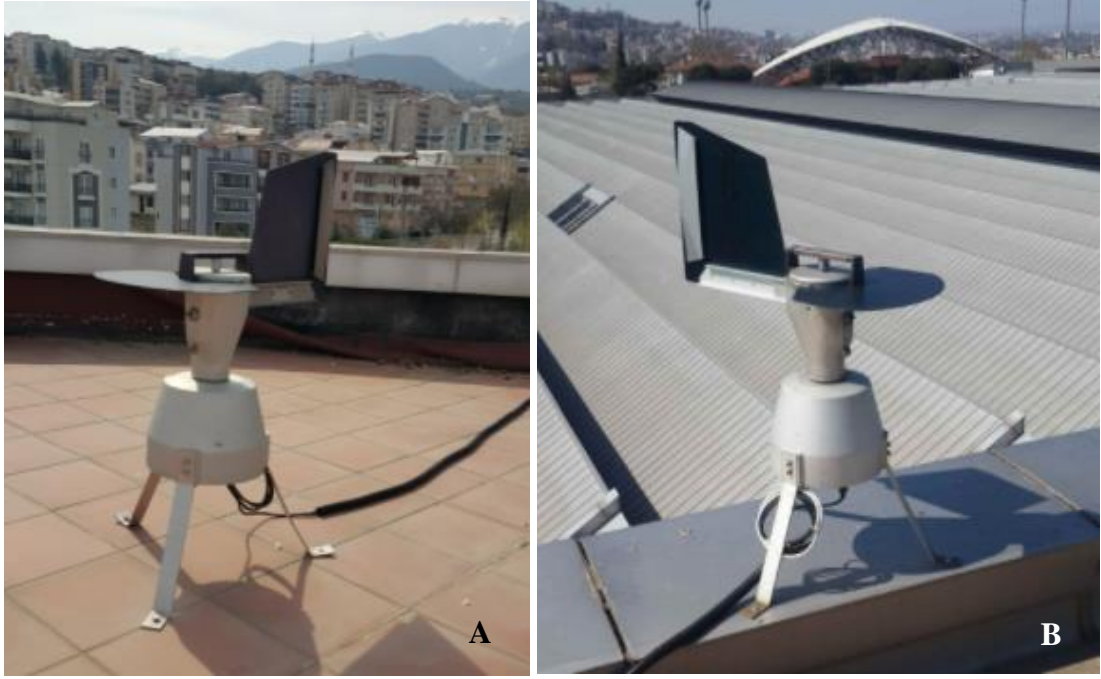
Şekil 3.13. Volümetrik polen tuzakları A) Kestel’de bulunan volümetrik polen tuzağı B) Merinos’ta bulunan volümetrik polen tuzakları
