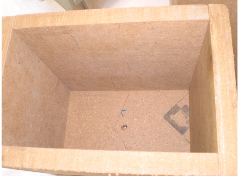
Şekil 2.6. Polyester Kumaşların Ozonlama Düzeneği: Kutunun Orta Alt Noktasında Ozon Difüzeri
