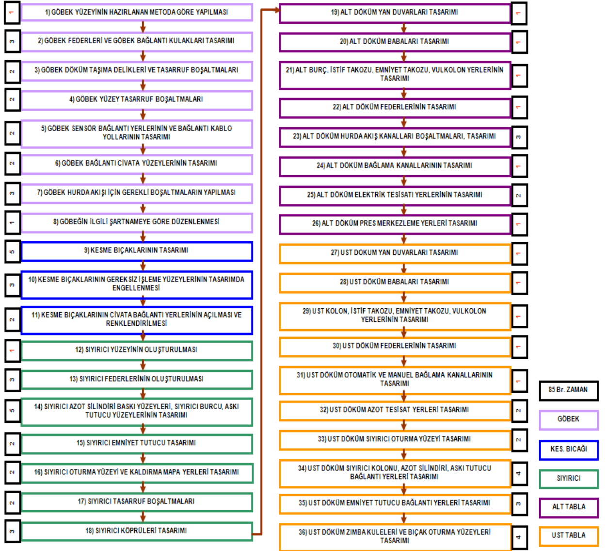
Şekil 5.6. Uzman sistem yaklaşımı ile hedeflenen kesme kalıbı tasarımı işlem adımları
