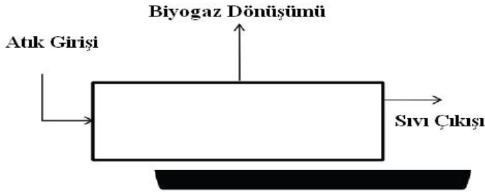
Şekil 2.17 Piston akışlı reaktörlerin şematik çizimi (Hamilton 2009)
