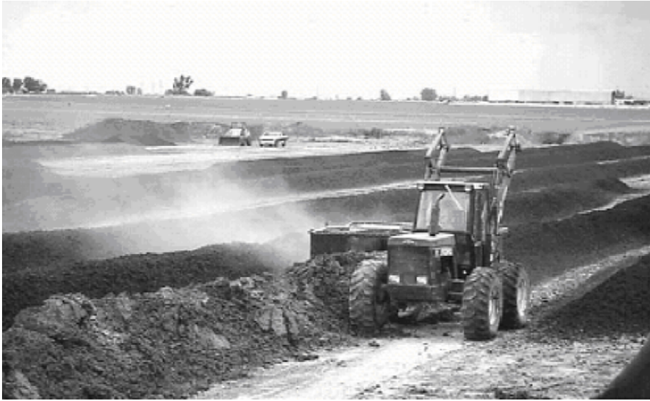
Şekil 2.8 Sıralı yığın kompostlama metodu (Öztürk M. 2008).
