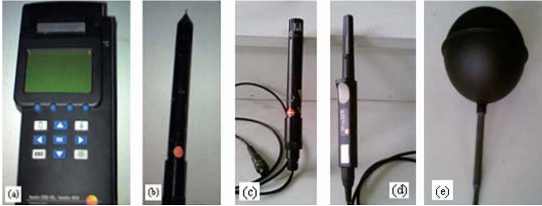
Şekil 3.20 (a) Testo 350 M/XL 454 veri toplama cihazı (b) sıcaklık,bağıl nem ve hava hızı ölçeri (3'lü) (c) sıcaklık ve bağıl nem ölçeri (2'li) (d) CO 2 ölçeri (e) Siyah küresel termometre
