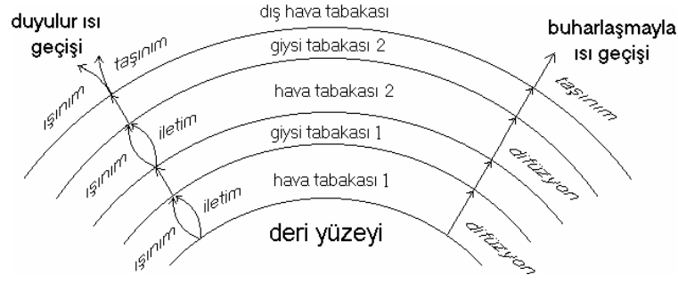
Şekil 3.4 Elbise üzerinden çevreye ısı geçişi (McCullough ve ark. 1989)
