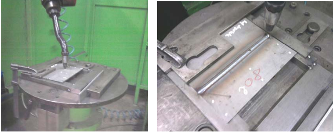
Şekil 3.11. Kaynatılacak parçaların kaynak robotuna tutturulması
