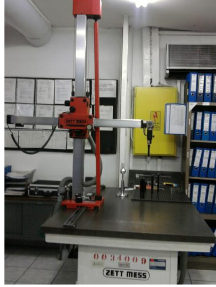
Şekil 3.3. Çarpımların ölçüldüğü 3D ölçüm cihazı
