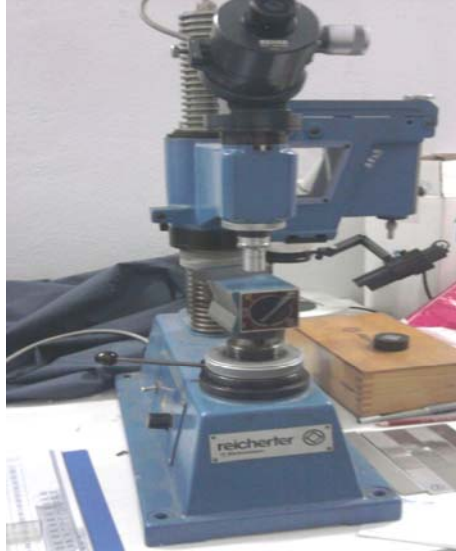
Şekil 3.6. Sertlik ölçümlerinin alındığı sertlik ölçme cihazı
