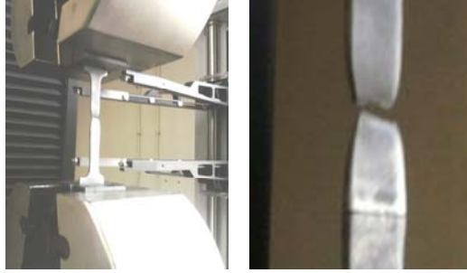
Şekil 3.14. Çekme testi sonrasında kopmuş malzeme
