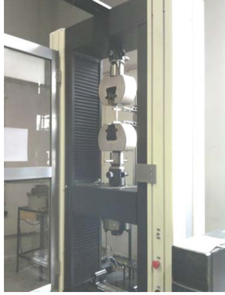
Şekil 3.5. Çekme testinin yapıldığı çekme test cihazı
