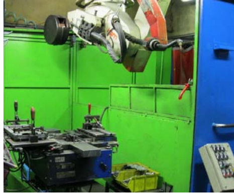
Ŗekil 3.1. Kaynak iŖleminde kullanılan kaynak robotu
