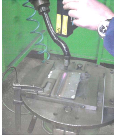
Şekil 3.12. Kaynak işleminin akabinde sıcaklık ölçümünün yapılması
