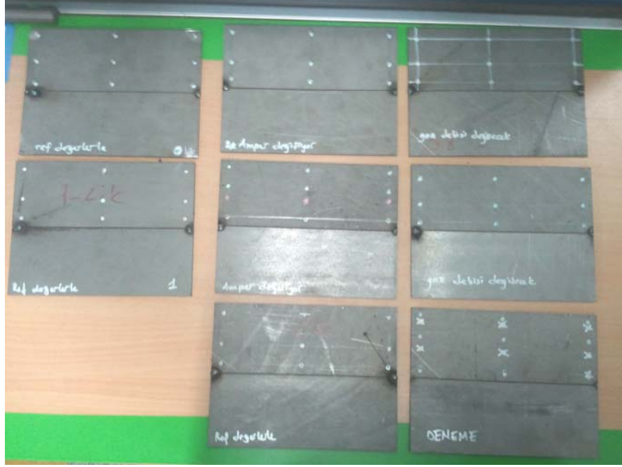
Şekil 3.9. Kaynak işlemine hazırlık amacıyla, iki parça kenarlarından puntalanmıştır
