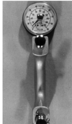
Şekil-15: Jamar el dinamometresi, önden görünüş.
