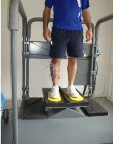
Şekil-4: Deneğin ani inversiyon platformundaki yerleşimi (nötral pozisyon)
