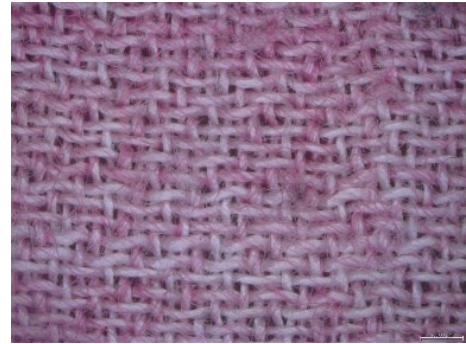
Şekil 4.7. Boncuklanma testi sonrası işlemsiz ve PVCL uygulanmış K-2 kumaşının yüzey görüntüsü A) İşlemsiz B) 40 g/l PVCL uygulanmış
