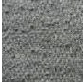
Şekil 2.1. Boncuklanma problemine sahip kumaş numunesi
