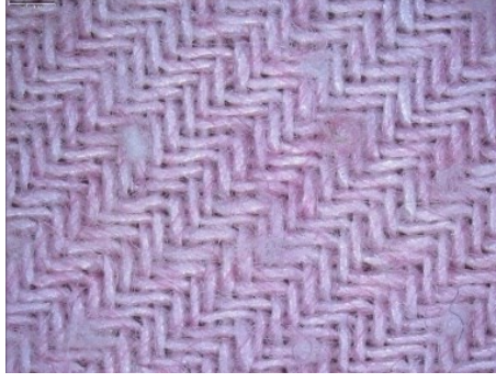
Şekil 4.11. Boncuklanma testi sonrası işlemsiz ve PVPA uygulanmış K-1 kumaşının yüzey görüntüsü A) İşlemsiz B) 40 g/l PVPA uygulanmış
