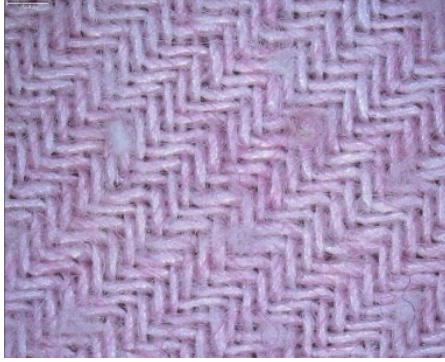
Şekil 4.6. Boncuklanma testi sonrası işlemsiz ve PVCL uygulanmış K-1 kumaşının yüzey görüntüsü A) İşlemsiz B) 40 g/l PVCL uygulanmış
