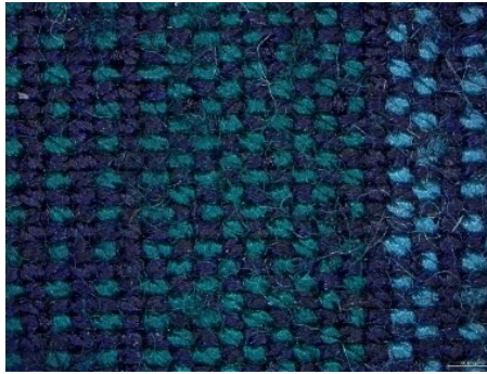
Şekil 4.4. Boncuklanma testi sonrası işlemsiz ve PVIM uygulanmış K-4 kumaşının yüzey görüntüsü A) İşlemsiz B) 50 g/l PVIM uygulanmış
