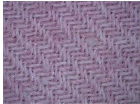
Şekil 4.16. Boncuklanma testi sonrası işlemsiz ve PVP uygulanmış K-1 kumaşının yüzey görüntüsü A) İşlemsiz B) 30 g/l PVP uygulanmış
