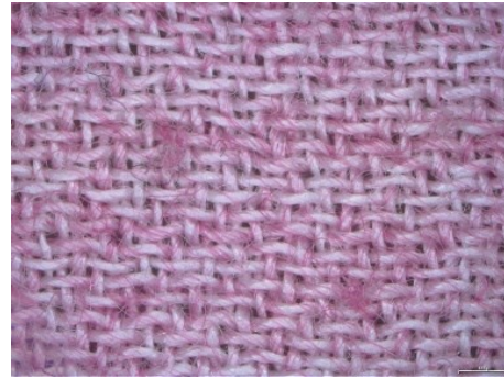
Şekil 4.22. Boncuklanma testi sonrası işlemsiz ve PVTAZ uygulanmış K-2 kumaşının yüzey görüntüsü A) İşlemsiz B) 10 g/l PVTAZ uygulanmış
