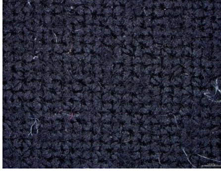
Şekil 4.5. Boncuklanma testi sonrası işlemsiz ve PVIM uygulanmış K-5 kumaşının yüzey görüntüsü A) İşlemsiz B) 50 g/l PVIM uygulanmış
