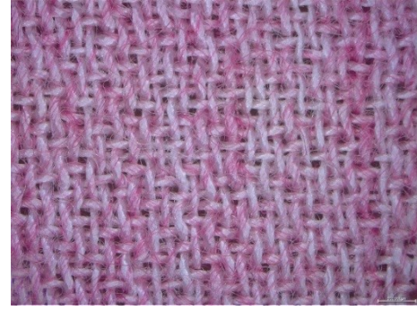
Şekil 4.27. İşlemsiz ve PVPA uygulanmış K-2 kumaşının yüzey görüntülerinin sararma açısından kıyaslanması A) İşlemsiz B) 40 g/l PVPA uygulanmış
