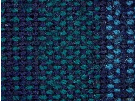
Şekil 4.14. Boncuklanma testi sonrası işlemsiz ve PVPA uygulanmış K-4 kumaşının yüzey görüntüsü A) İşlemsiz B) 40 g/l PVPA uygulanmış
