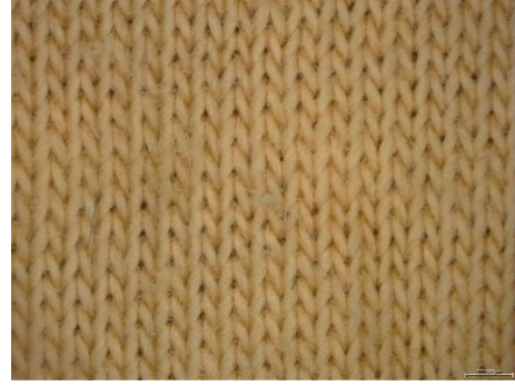
Şekil 4.18. Boncuklanma testi sonrası işlemsiz ve PVP uygulanmış K-3 kumaşının yüzey görüntüsü A) İşlemsiz B) 30 g/l PVP uygulanmış
