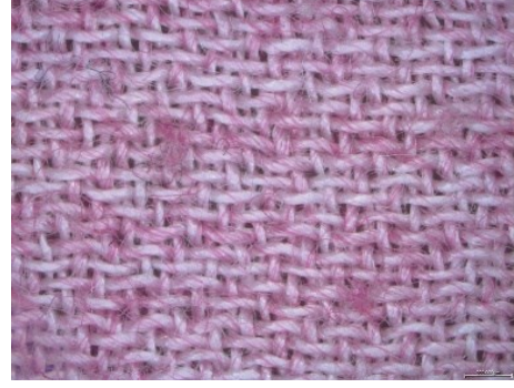
Şekil 4.17. Boncuklanma testi sonrası işlemsiz ve PVP uygulanmış K-2 kumaşının yüzey görüntüsü A) İşlemsiz B) 30 g/l PVP uygulanmış
