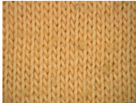
Şekil 4.13. Boncuklanma testi sonrası işlemsiz ve PVPA uygulanmış K-3 kumaşının yüzey görüntüsü A) İşlemsiz B) 40 g/l PVPA uygulanmış
