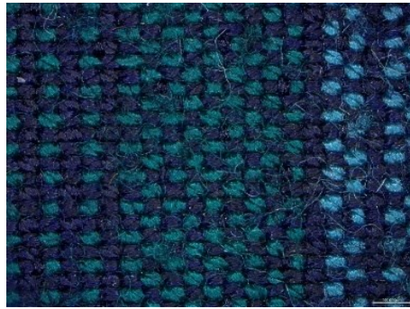
Şekil 4.19. Boncuklanma testi sonrası işlemsiz ve PVP uygulanmış K-4 kumaşının yüzey görüntüsü A) İşlemsiz B) 30 g/l PVP uygulanmış
