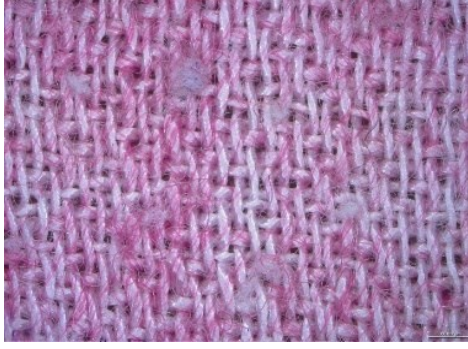
Şekil 4.2. Boncuklanma testi sonrası işlemsiz ve PVIM uygulanmış K-2 kumaşının yüzey görüntüsü A) İşlemsiz B) 50 g/l PVIM uygulanmış
