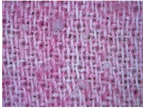
Şekil 4.22. Boncuklanma testi sonrası işlemsiz ve PVTAZ uygulanmış K-2 kumaşının yüzey görüntüsü A) İşlemsiz B) 10 g/l PVTAZ uygulanmış
