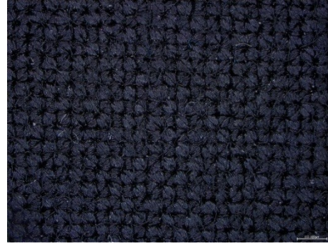
Şekil 4.30. İşlemsiz ve PVPA uygulanmış K-5 kumaşının yüzey görüntülerinin sararma açısından kıyaslanması A) İşlemsiz B) 40 g/l PVPA uygulanmış
