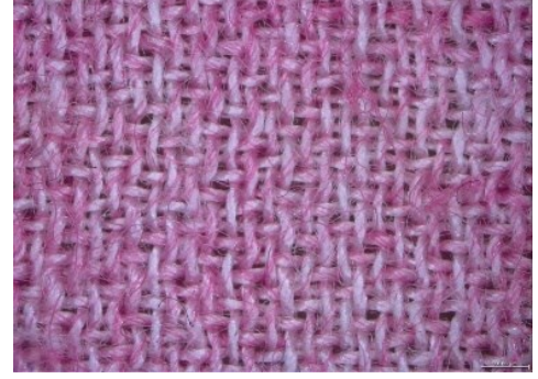
Şekil 4.2. Boncuklanma testi sonrası işlemsiz ve PVIM uygulanmış K-2 kumaşının yüzey görüntüsü A) İşlemsiz B) 50 g/l PVIM uygulanmış
