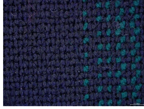
Şekil 4.29. İşlemsiz ve PVPA uygulanmış K-4 kumaşının yüzey görüntülerinin sararma açısından kıyaslanması A) İşlemsiz B) 40 g/l PVPA uygulanmış
