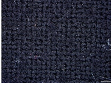
Şekil 4.20. Boncuklanma testi sonrası işlemsiz ve PVP uygulanmış K-5 kumaşının yüzey görüntüsü A) İşlemsiz B) 30 g/l PVP uygulanmış
