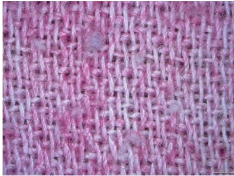
Şekil 4.7. Boncuklanma testi sonrası işlemsiz ve PVCL uygulanmış K-2 kumaşının yüzey görüntüsü A) İşlemsiz B) 40 g/l PVCL uygulanmış
