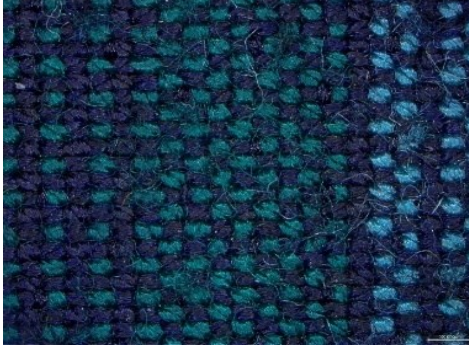
Şekil 4.9. Boncuklanma testi sonrası işlemsiz ve PVCL uygulanmış K-4 kumaşının yüzey görüntüsü A) İşlemsiz B) 40 g/l PVCL uygulanmış
