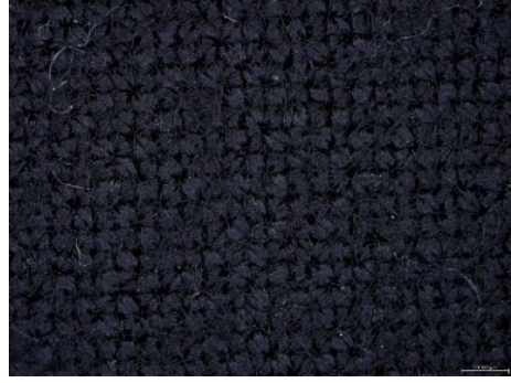
Şekil 4.15. Boncuklanma testi sonrası işlemsiz ve PVPA uygulanmış K-5 kumaşının yüzey görüntüsü A) İşlemsiz B) 40 g/l PVPA uygulanmış
