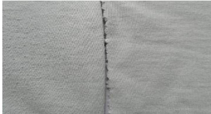
A B Şekil 2.7. İşlemsiz ve anti-boncuklanma kimyasalı uygulanmış kumaşların görüntüsü A) İşlemsiz B) Kimyasal uygulandıktan sonra
