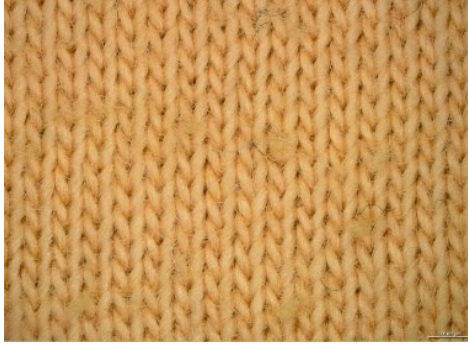
Şekil 4.3. Boncuklanma testi sonrası işlemsiz ve PVIM uygulanmış K-3 kumaşının yüzey görüntüsü A) İşlemsiz B) 50 g/l PVIM uygulanmış
