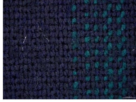
Şekil 4.14. Boncuklanma testi sonrası işlemsiz ve PVPA uygulanmış K-4 kumaşının yüzey görüntüsü A) İşlemsiz B) 40 g/l PVPA uygulanmış
