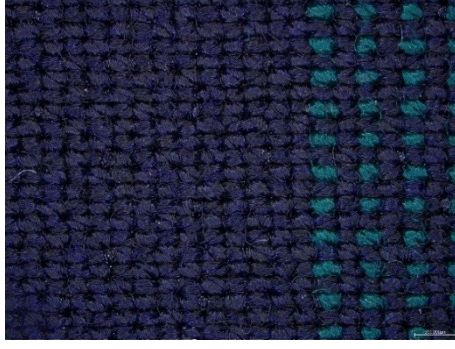
Şekil 4.29. İşlemsiz ve PVPA uygulanmış K-4 kumaşının yüzey görüntülerinin sararma açısından kıyaslanması A) İşlemsiz B) 40 g/l PVPA uygulanmış
