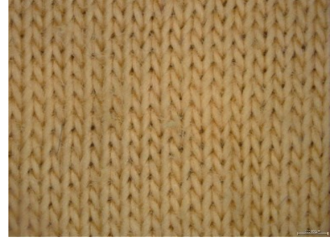
Şekil 4.23. Boncuklanma testi sonrası işlemsiz ve PVTAZ uygulanmış K-3 kumaşının yüzey görüntüsü A) İşlemsiz B) 10 g/l PVTAZ uygulanmış
