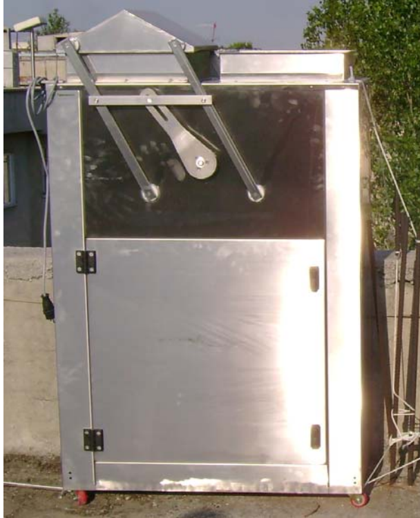
Şekil 3.13 IKÇÖ'nin Önden (Kuru Çökme Haznesi Kapalı) Görünüşü
