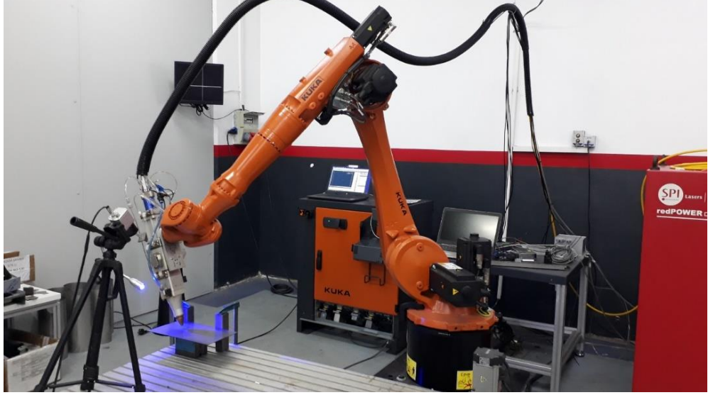
Şekil 3.1. Lazer kaynak cihazı ve termal kamera ekipmanları
