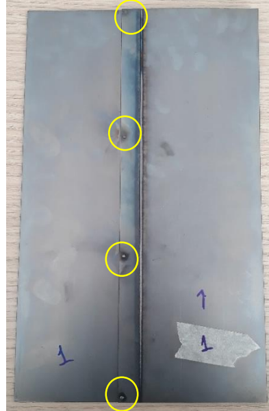
Şekil 3.4. Lazer kaynak işlemi öncesi uygulanan punto kaynak noktaları
