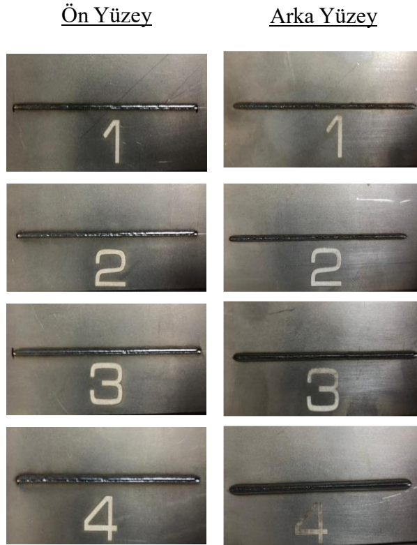
Şekil 4.1. Ön deneme çalışması ile elde edilen lazer kaynaklı bağlantılar (“1” numaralı numune ısı girdisi: 35,71 J/mm, “2” numaralı numune ısı girdisi: 37,60 J/mm, “3” numaralı numune ısı girdisi: 45,45 J/mm, “4” numaralı numune ısı girdisi: 62,5 J/mm)
