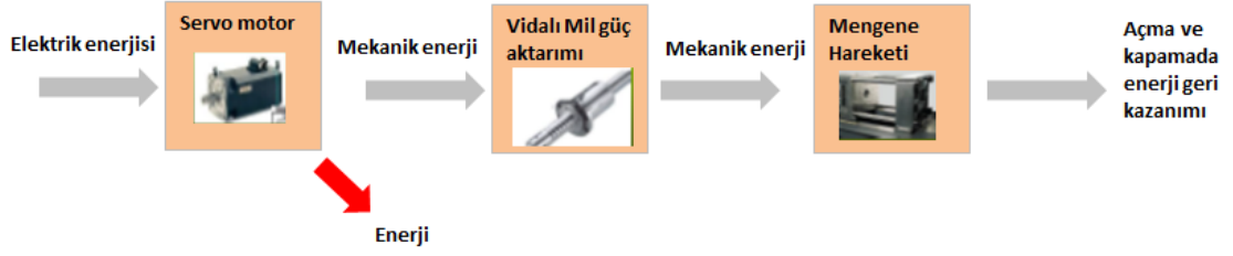
Şekil 2.4. Elektrikli Plastik Enjeksiyon Makineleri Çalışma Prensibi
