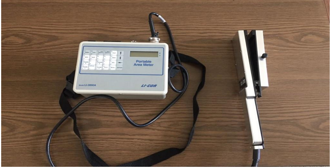
Şekil 3.6. Bayrak yaprak alan ölçüm cihazı
