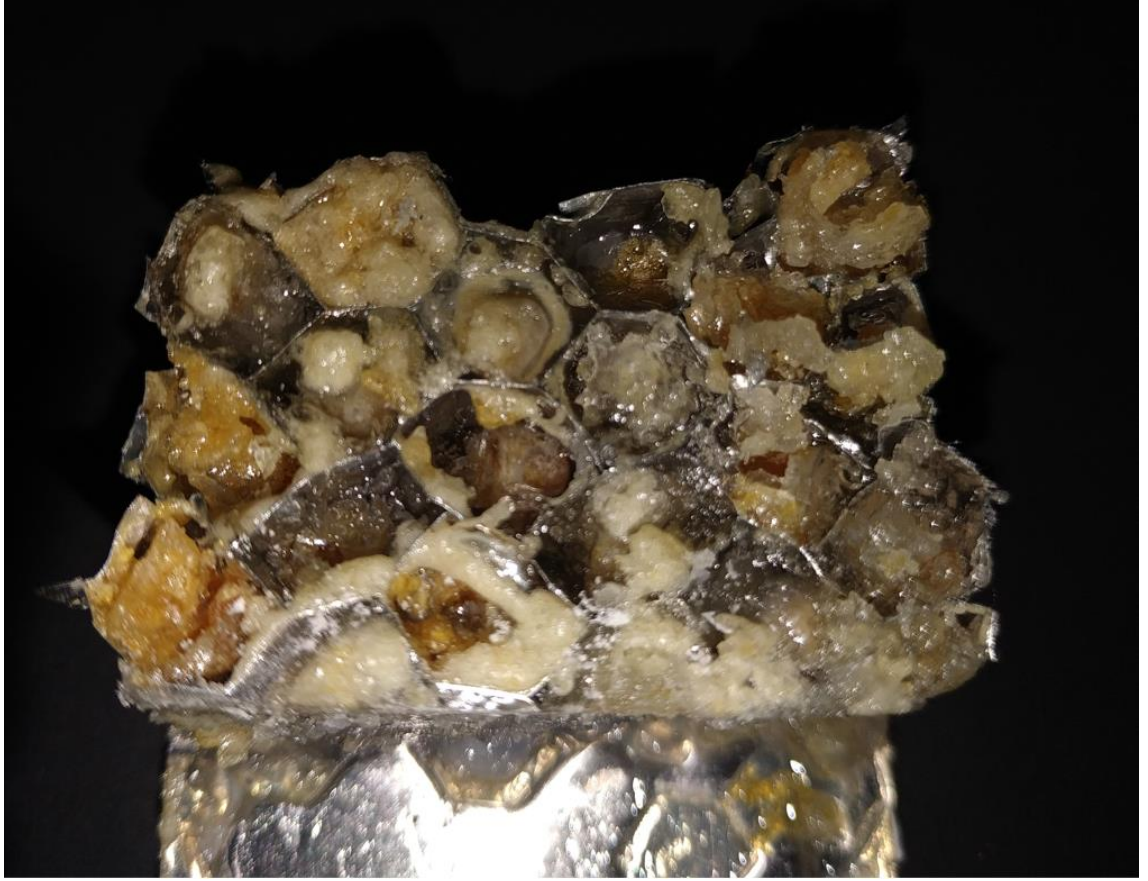
Şekil 3. 23. 1. Deney sonrası bası numunesinde meydana gelen iyileşme görüntüsü.
