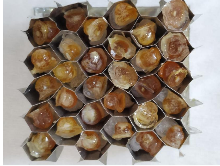
Şekil 3. 16. Kapsüllerin bal peteği hücrelerine yerleştirilmesi.
