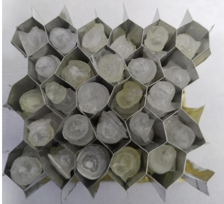
Şekil 3. 7. Makro kapsüllerin Al bal peteği hücrelerine yerleştirilmesi.
