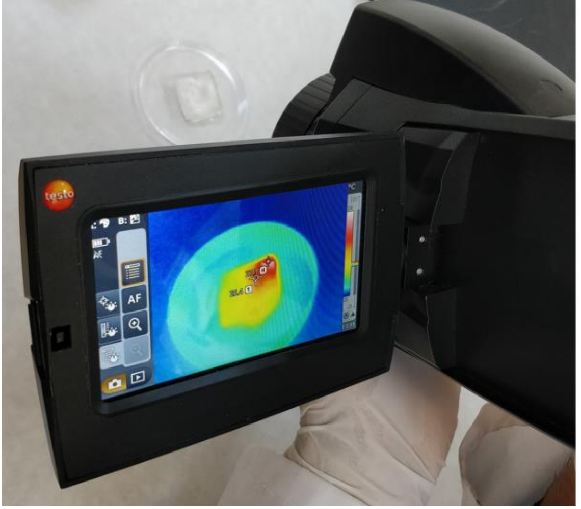
Şekil 3. 34. Tepkime esnasında meydana gelen ısı değerlerinin termal kamera ile ölçümü.
