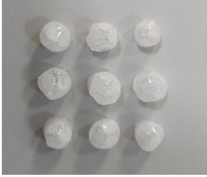
Şekil 3. 32. Üç katmanlı epoksi makro kapsül.
