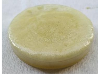
Şekil 3. 19. Dış etken sonrası poliüretan köpürmesi.
