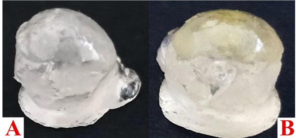
Şekil 3. 5. Epoksi reçine ve aktivatör enjekte edilmiş makro kapsüller.
