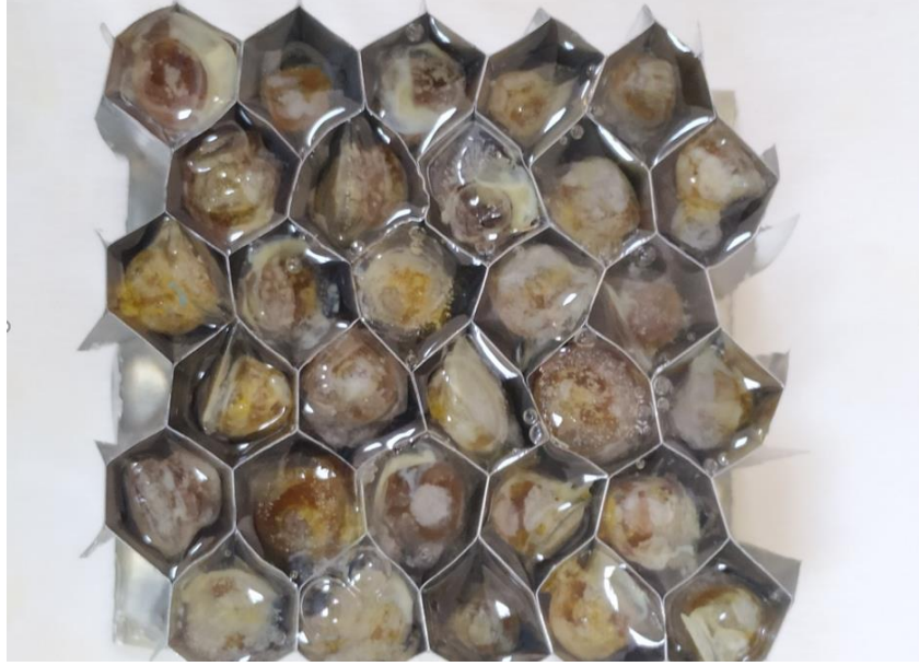
Şekil 3. 17. Boş bal peteği hacimlerinin epoksi ile doldurulması.
