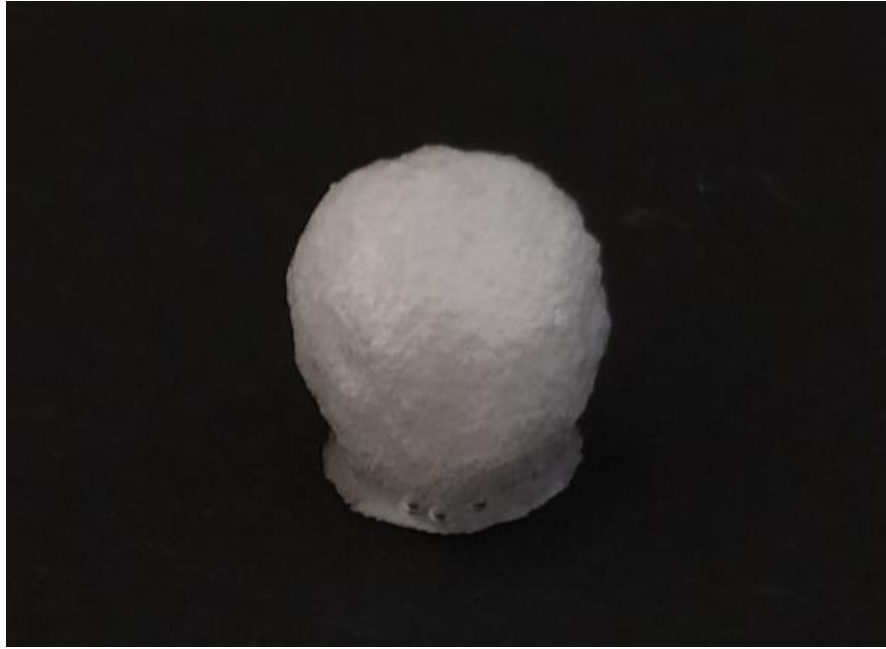
Şekil 3. 2. Polistren tanesinin epoksi ve \text{NaHCO}_3 ile kaplanması.
