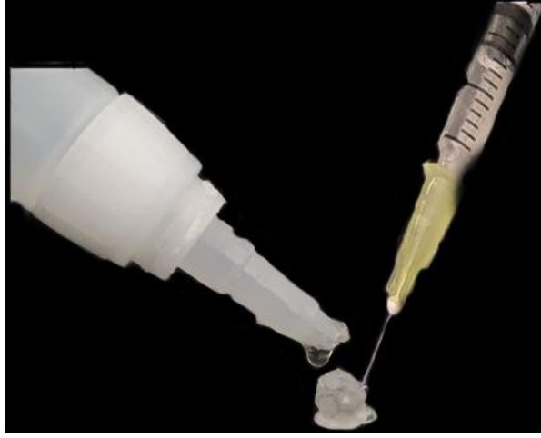
Şekil 3. 6. Enjektör deliklerinin kapatılması.
