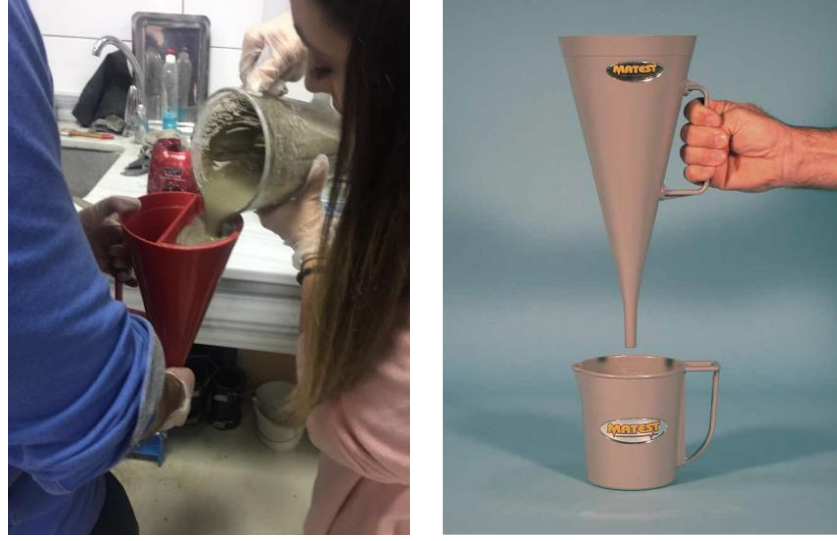
Şekil 3.4. Marsh hunisi akış süresi deneyinin uygulanması
