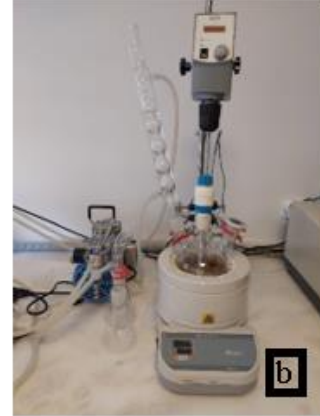
Şekil 3.1. (a) Esterifikasyon reaksiyonu genel gösterimi (b) Pilot Reaktör düzeneği
