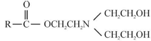
Trietanolaminin karboksilik asit monoesterinin moleküler yapısı
