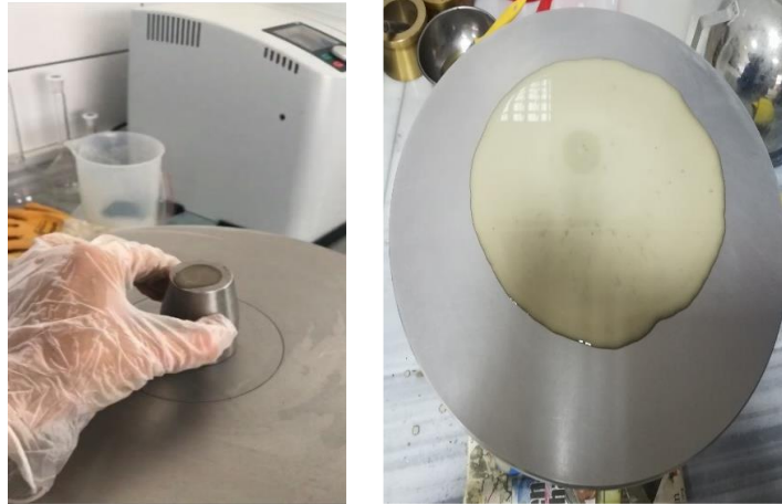
Şekil 3.5. Mini yayılma deneyinin uygulanması
