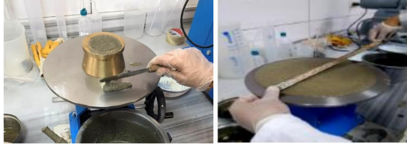
Şekil 3.8. Harç karışımlarının yayılma deneyi
