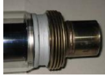
Şekil 3.5. Körükle birleştirilmiş emici boru-cam örtü (Şanlı, 2010)
