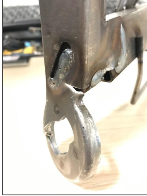
Şekil 4.3. Fiziksel testte oluşan braketteki yırtılma
