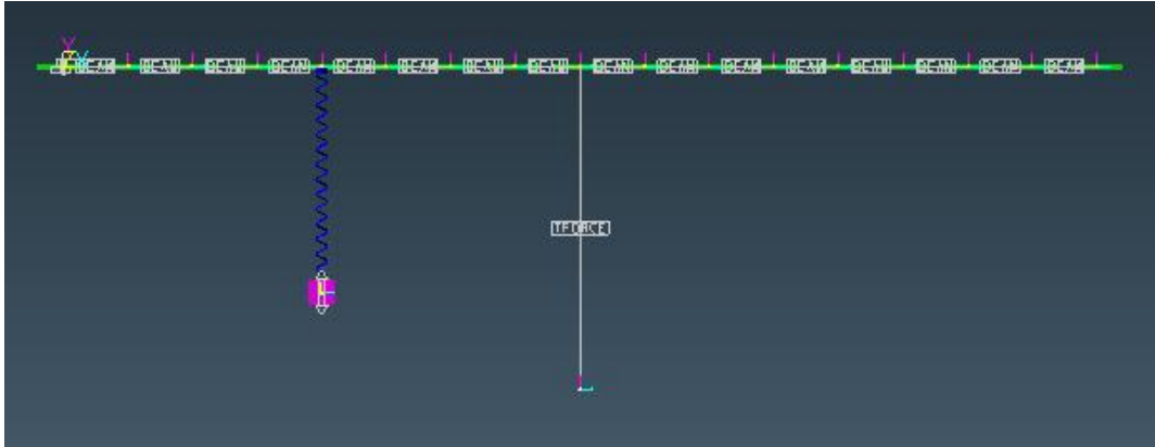
Şekil 4.3 Lineer absorberli sistem için Recurdyn içinde oluşturulan simülasyon modeli
