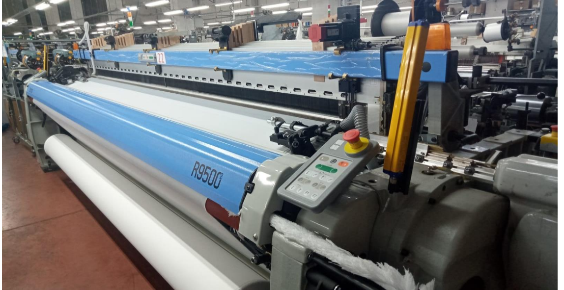
Şekil 3.2. Numune dokuma kumaşların üretildiği armürlü dokuma makinesi
