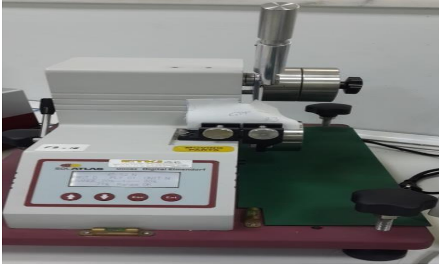
Şekil 3.7. Dijital Elmendorf cihazı
