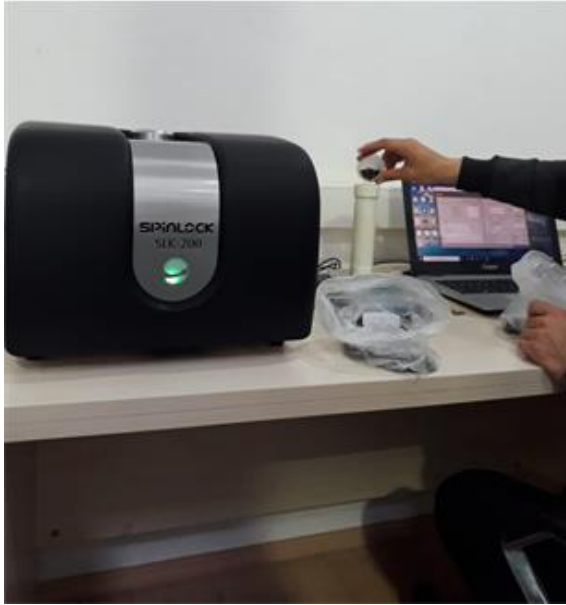
Şekil 3.7. Yağ analizinde kullanılan NMR cihazı
