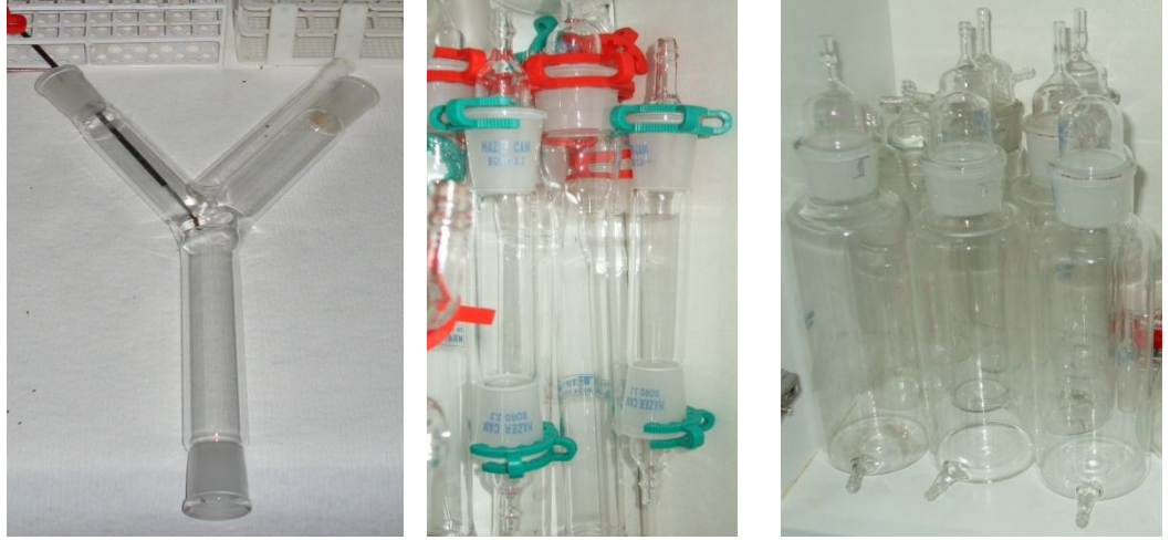
Şekil 3.7. Olfaktometrenin kısımlarından Y şeklinde Pyrex tüp, tüpler ve fanuslar.
