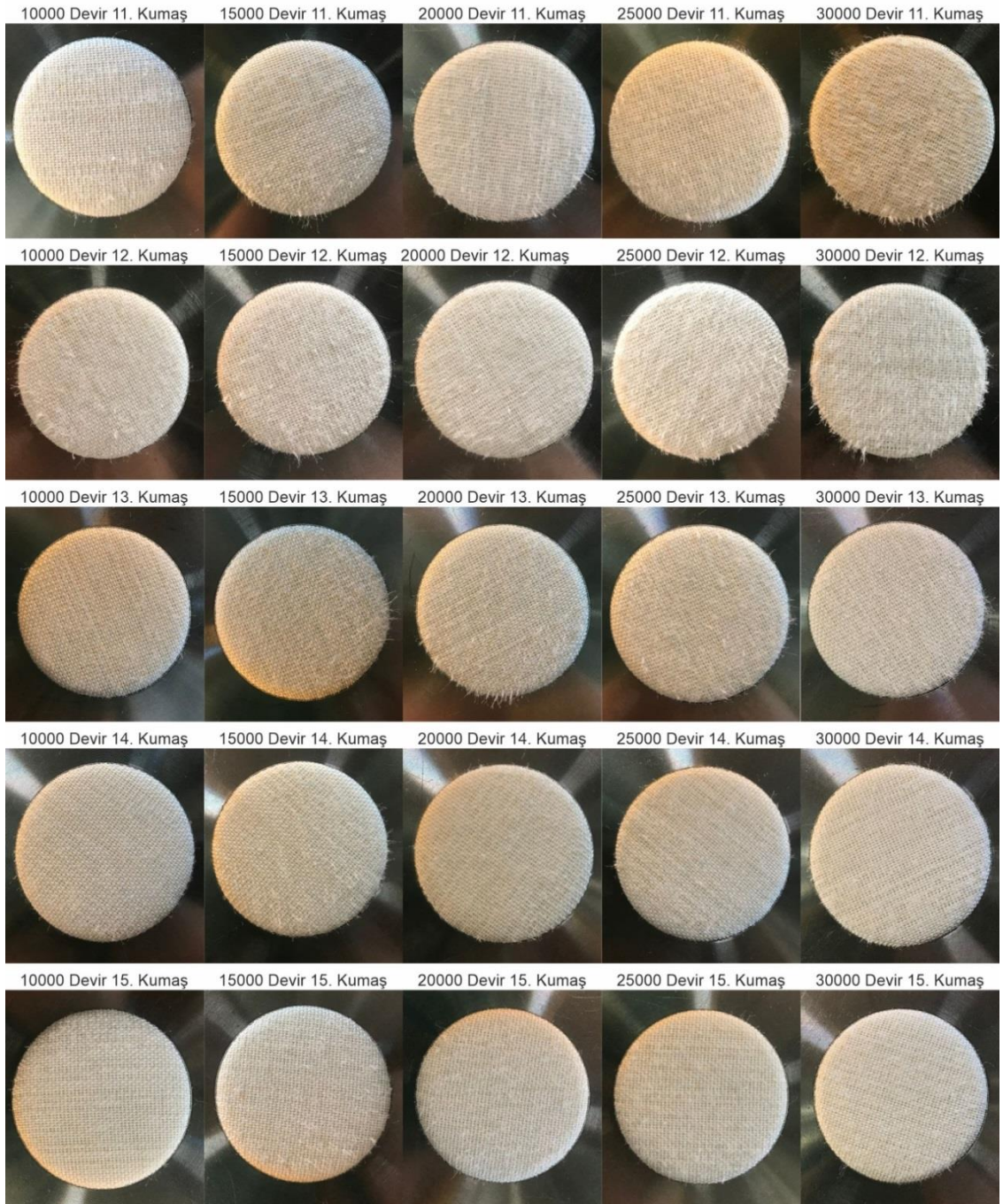
Şekil 4.42. 11.,12.,13.,14.,15. kumaşların 10000, 15000, 20000, 25000, 30000 devir sonrası görselleri (2.Deneme)
