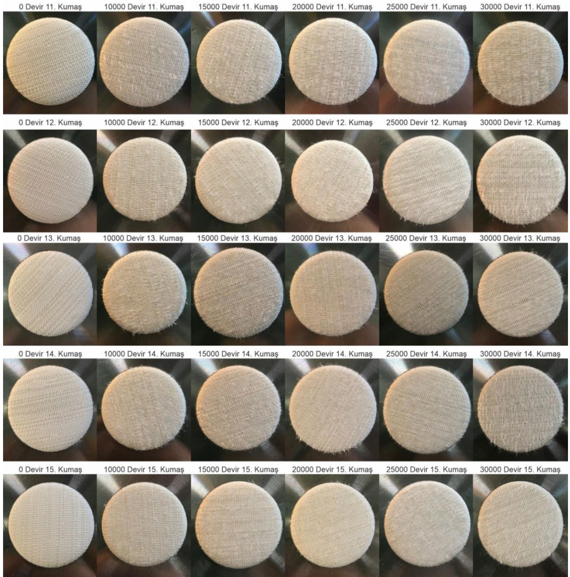
Şekil 4.45. 11.,12.,13.,14.,15. kumaşların test öncesi, 10000, 15000, 20000, 25000, 30000 devir sonrası görselleri (3.Deneme)
