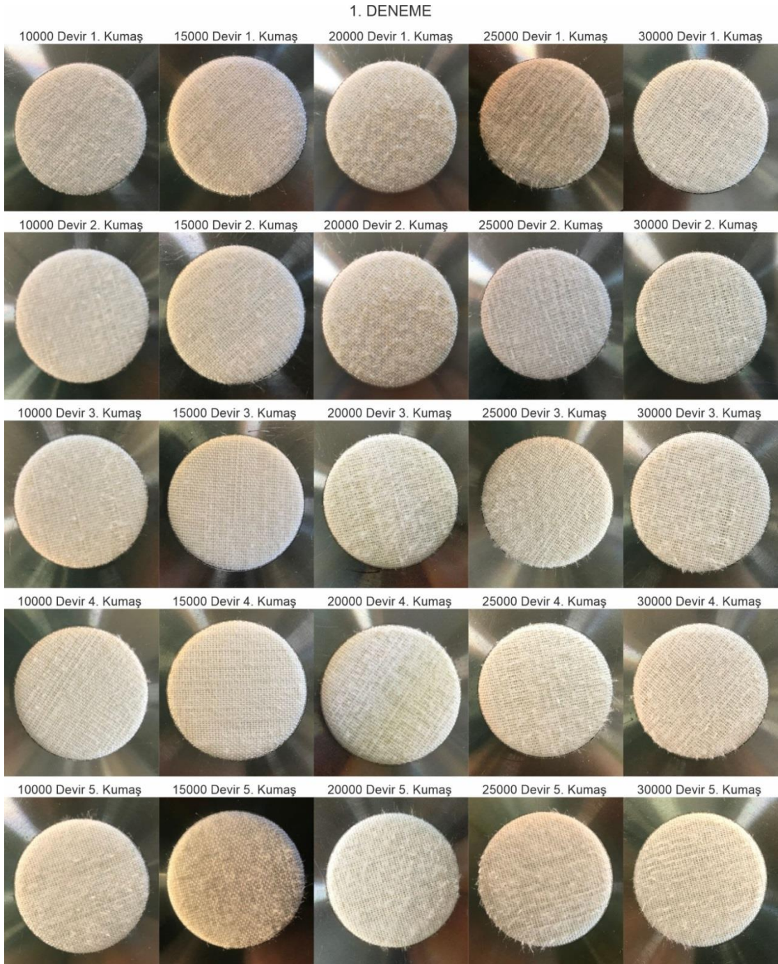
Şekil 4.37. 1.,2.,3.,4.,5. kumaşların 10000, 15000, 20000, 25000, 30000 devir sonrası görselleri (1.Deneme)
