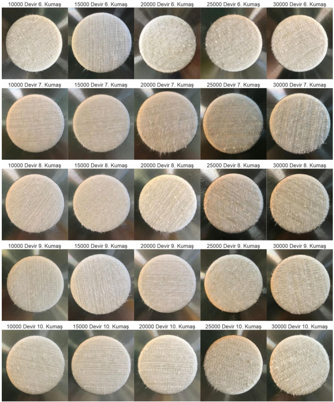
Şekil 4.38. 6.,7.,8.,9.,10. kumaşların 10000, 15000, 20000, 25000, 30000 devir sonrası görselleri (1.Deneme)
