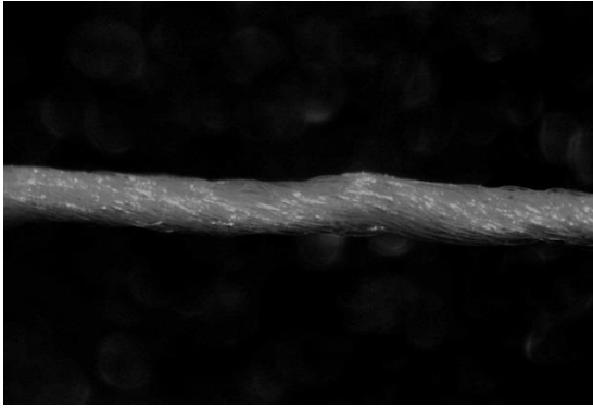
Şekil 4.10. PET/BİO-PET kombinasyonu kompozit iplik mikroskop görüntüsü
