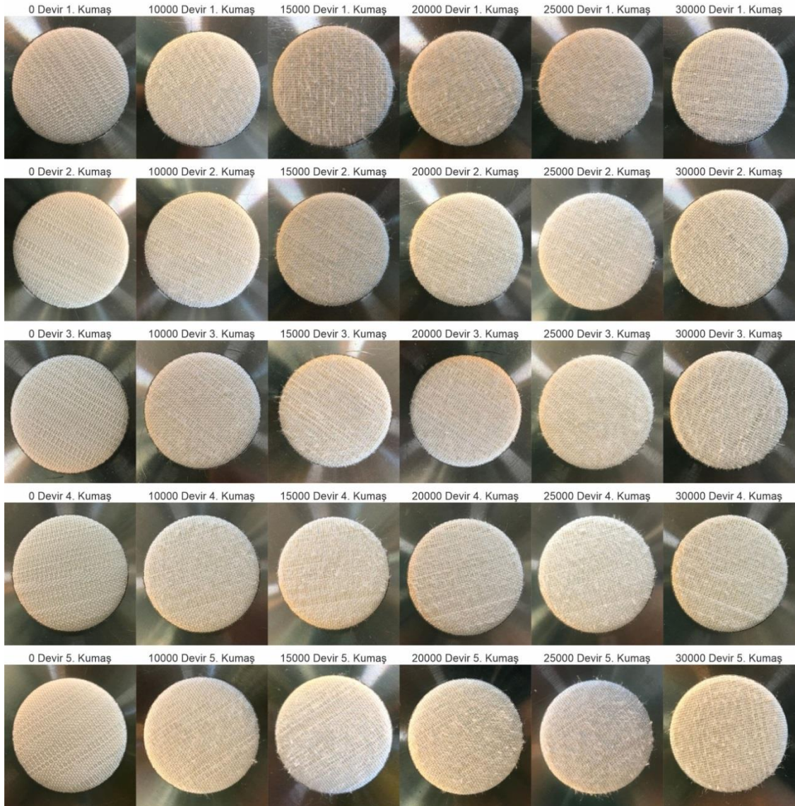
Şekil 4.43. 1.,2.,3.,4.,5. Kumaşların test öncesi, 10000, 15000, 20000, 25000, 30000 devir sonrası görselleri (3.Deneme)
