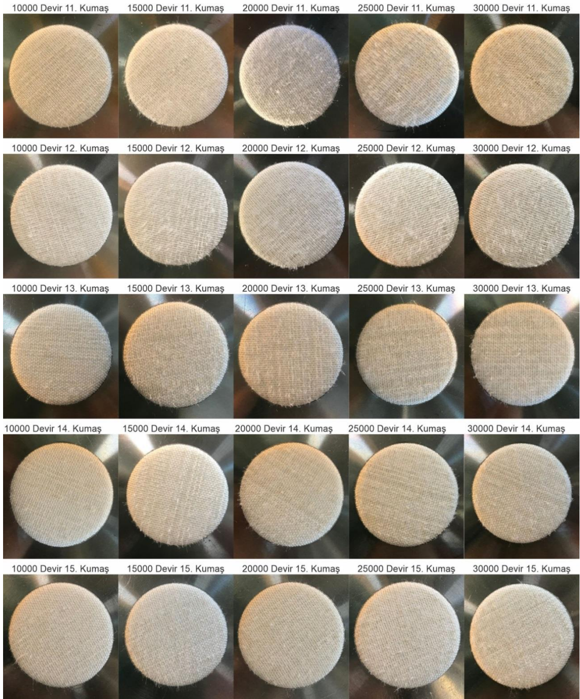
Şekil 4.39. 11.,12.,13.,14.,15. kumaşların 10000, 15000, 20000, 25000, 30000 devir sonrası görselleri (1.Deneme)
